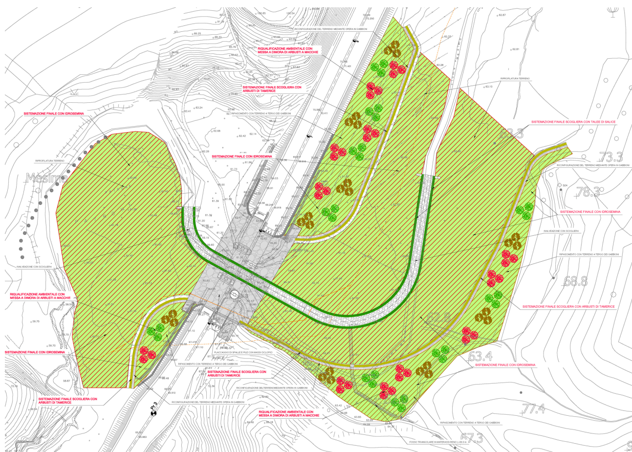
Stralcio dell'intervento di ripristino ed inserimento ambientale in corrispondenza del viadotto Mesima 2
