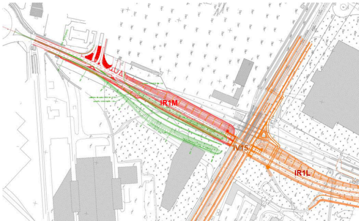
Figura 22 – Localizzazione della rampa di approccio IR1M nel progetto approvato (in colore verde) ed in variante (colore rosso)
