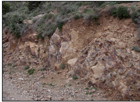
Fig. 18 - Metarenarie con sistemi di discontinuità a spaziatura pluricentimetrica: uno immerge di 50° verso NNE (scistosità che traspone la stratificazione); un altro, diretto NE-SW (fratture), è sub-verticale e ben spaziato. Affioramento a sud di "Perdabila".
