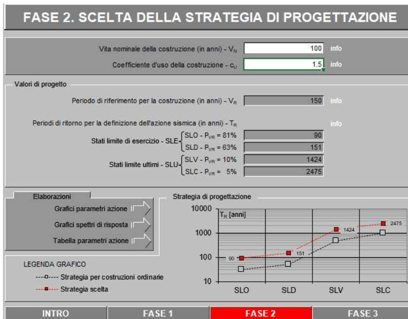
Figura 23. Vita di progetto della costruzione.
