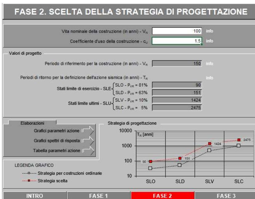
Figura 2. Vita di progetto della costruzione.
