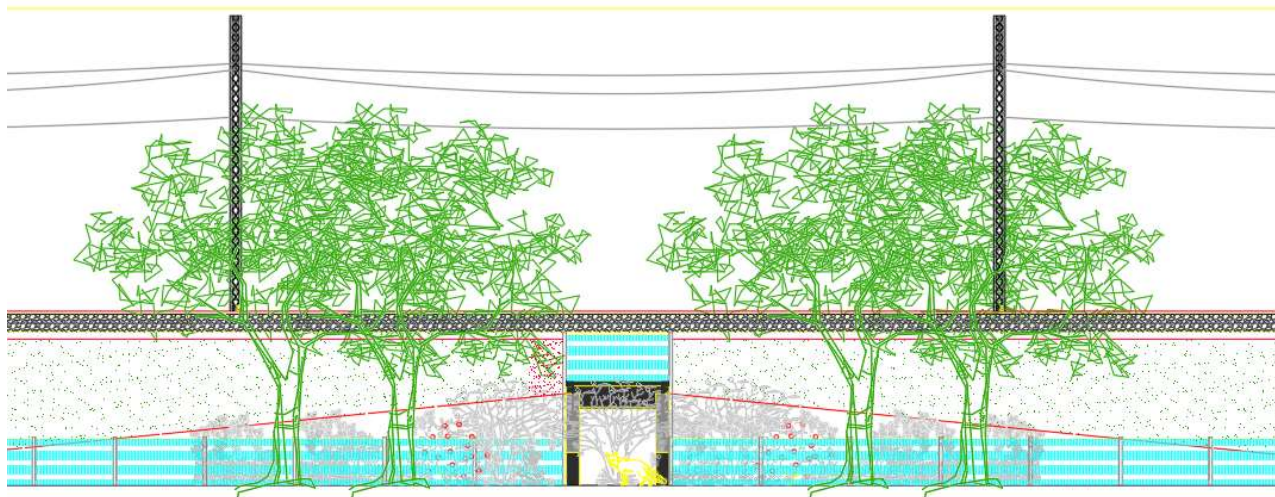
Figura 10/3: imbocco del varco faunistico con vegetazione agli imbocchi affermata, nell'immagine è visibile (in azzurro) la recinzione posizionata per impedire alla fauna l'accesso alla sede ferroviaria, indirizzandola verso il varco stesso
