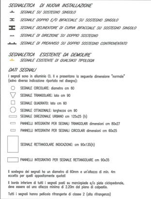
LA SEGNALETICA VERTICALE E' DI TIPO "NORMALE" (Art. 80 del Reg. 30 c.d.s.) CON SISTEMI TUBULARI IN ACCIAIO ZINCATO COMPLETI DI SISTEMI ANTIVIBRAZIONE E BLOCCO DI FONDAZIONE IN C.I.S.
