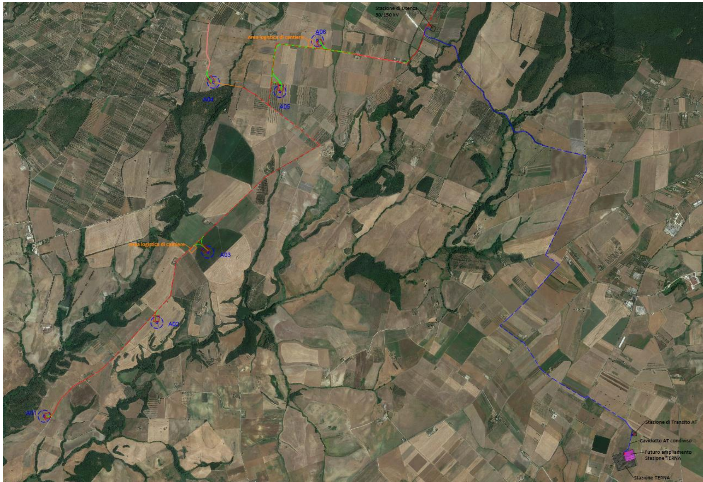
Figura 2.4 Corografia su base Fotopiano con individuazione del sottocampo Sud Ovest della centrale eolica , del tracciato del cavidotto interrato MT (in rosso) e AT(in blu) , della SE Utente e della SE TERNA “Tuscania”.
