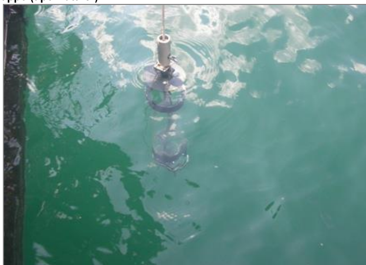
Figura 12-2: bottiglia a strappo (tipo Ruttner)
