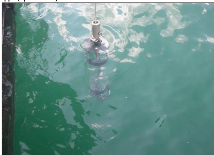
Figura 12-3: bottiglia a strappo (tipo Ruttner).
