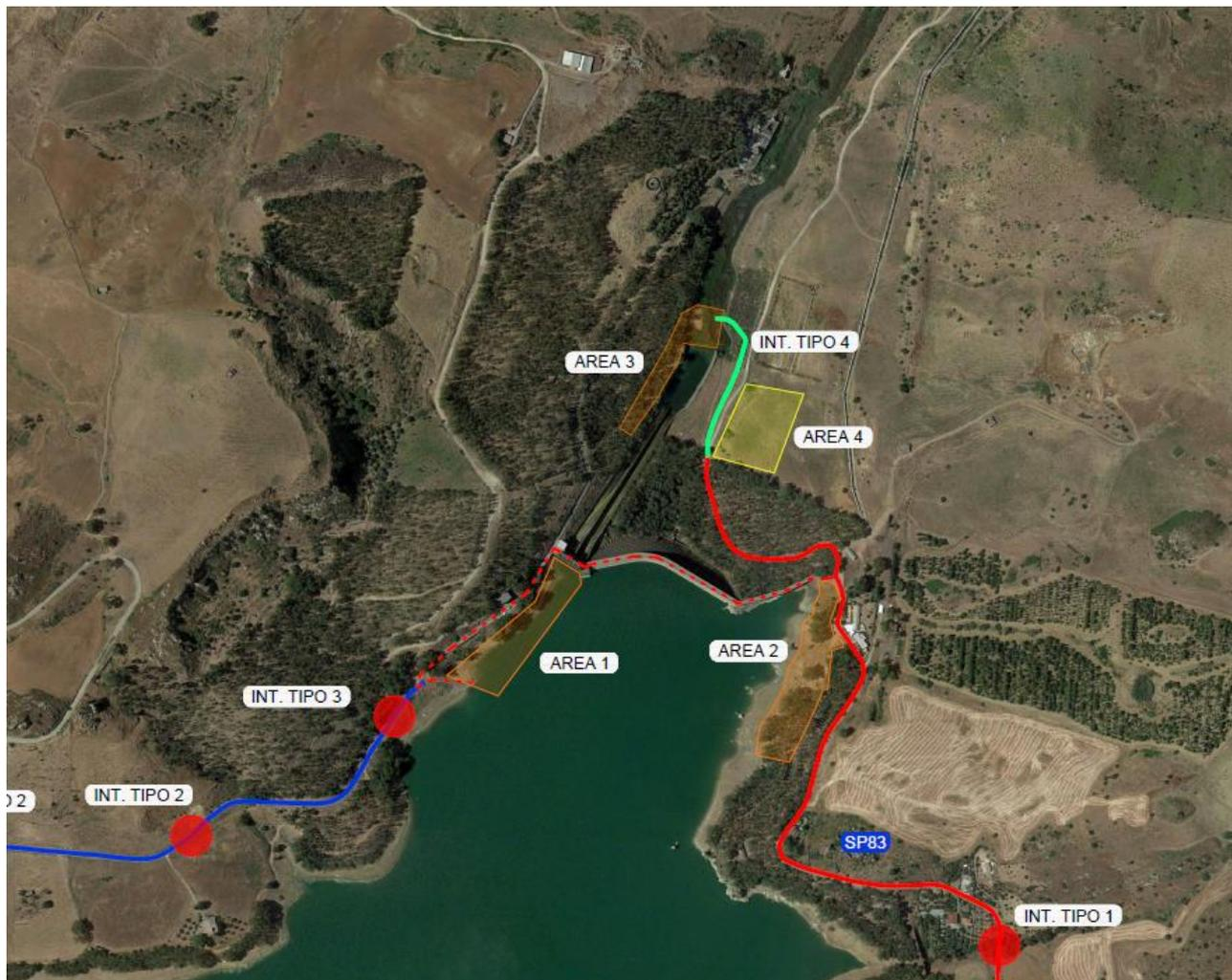
Figura 6-19. Localizzazione delle aree di cantiere estratta dall'elaborato "Percorsi di cantiere e ubicazione dei siti di cava e di deposito"
