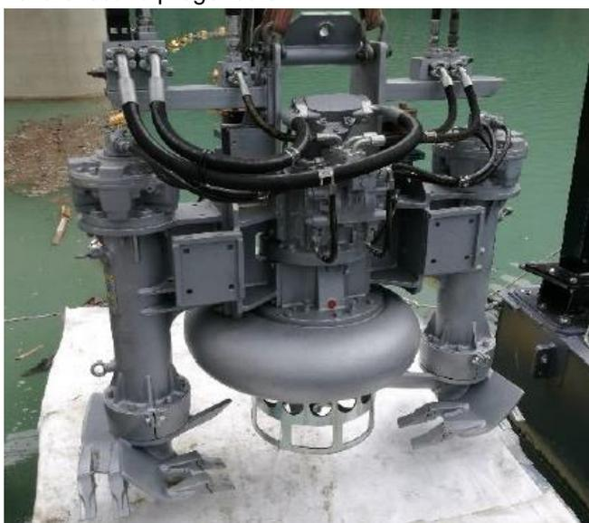
**Figura 5-15. Esempio di pompa idraulica sommergibile**
