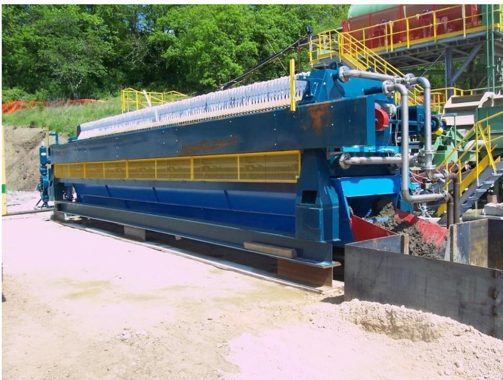
Figura 5-21. Esempio di filtropressa
