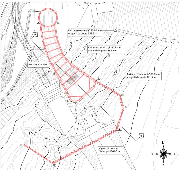
Fase 1: Perforazione opere di ritenuta idraulica (pali interconnessi), e riempimento con cls fino a quota 341.50 m
