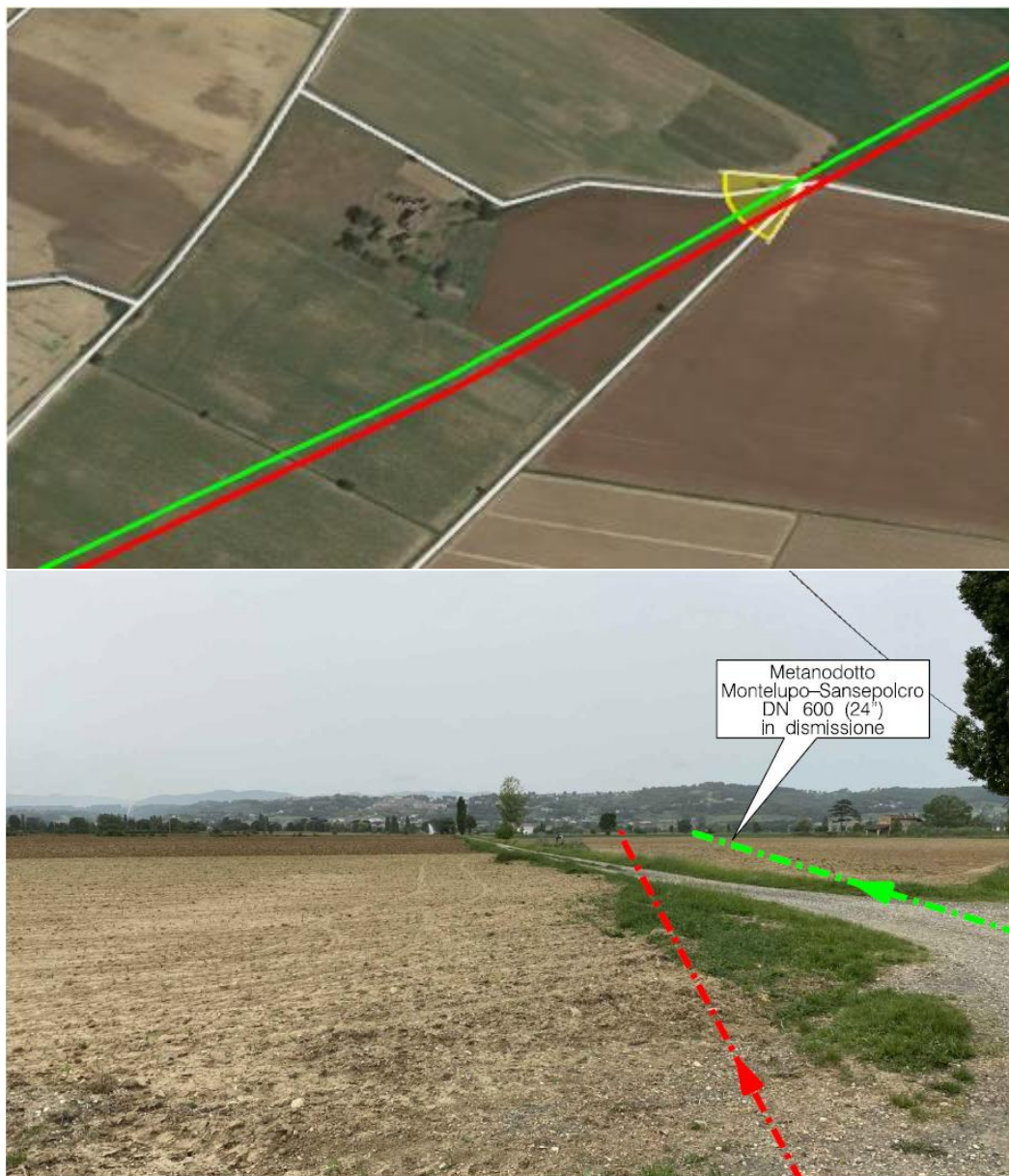
Foto 3/B - Panoramica dei tracciati in progetto e in dismissione in parallelismo lungo la piana alluvionale del Fiume Tevere.
