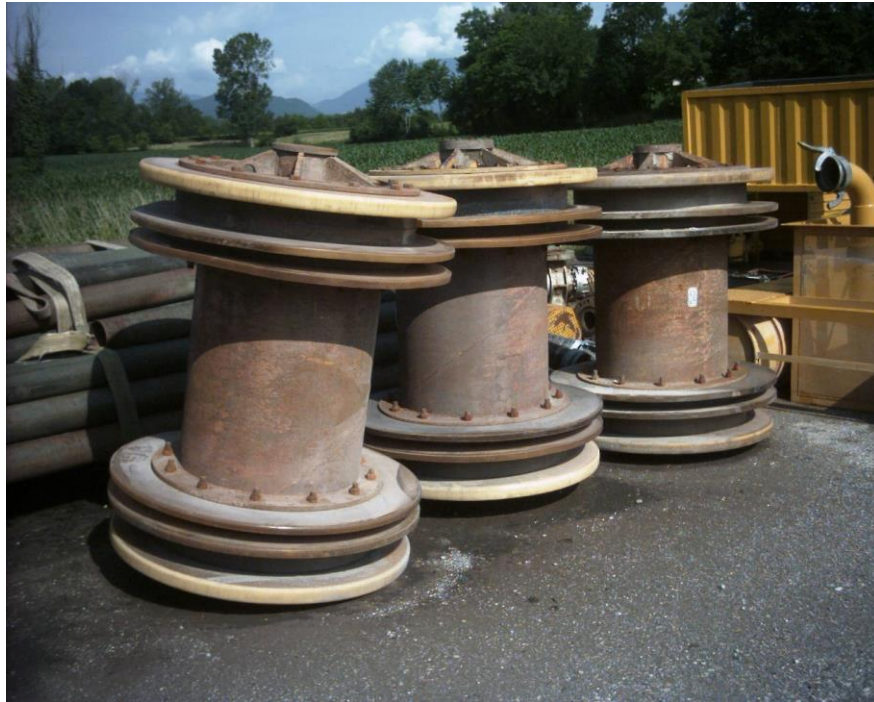
Figura 3.3.8.1/B: Pig per collaudo idraulico
