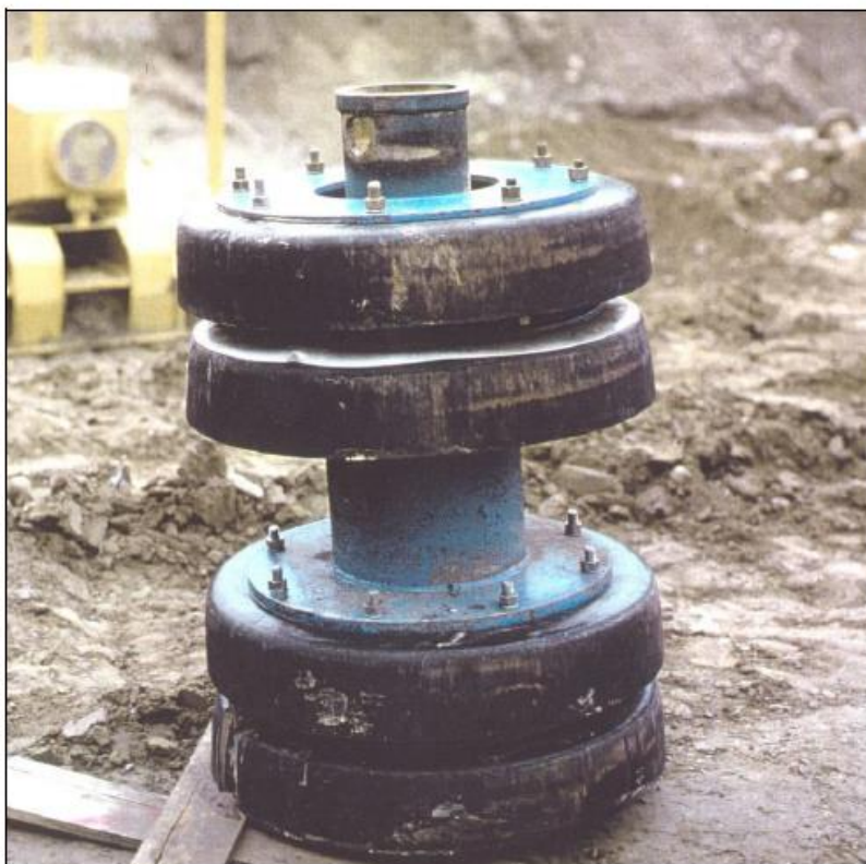
Figura 3.3.9.2/A: Pig convenzionale impiegato nelle operazioni di collaudo idraulico e di pulizia della condotta
