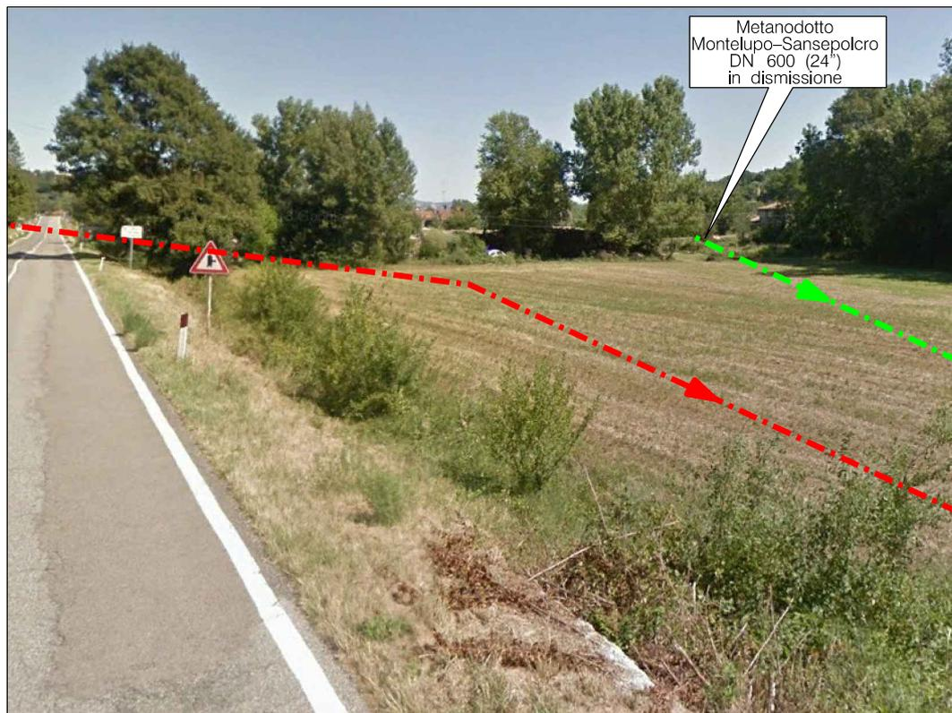
Arrivo del Microtunnell "Bargellino" in prossimita' della S.P. n. 43 della Libbia e percorrenza del fondovalle del Torrente Libbia in parallelismo con il Metanodotto esistente
