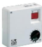
Gruppo comandi elettronico per ventilatori Vortice. Alimentazione monofase 220-240 V / 50-60 Hz. Installazione a parete, trasformabile ad incasso con il kit opzionale SCB. Colore bianco. Carico massimo ammissibile: 1.5 A. Funzioni: On/Off, Selezione continua della velocità.
