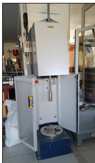
Fig. 4 Compattatore Proctor "Matest SpA"
