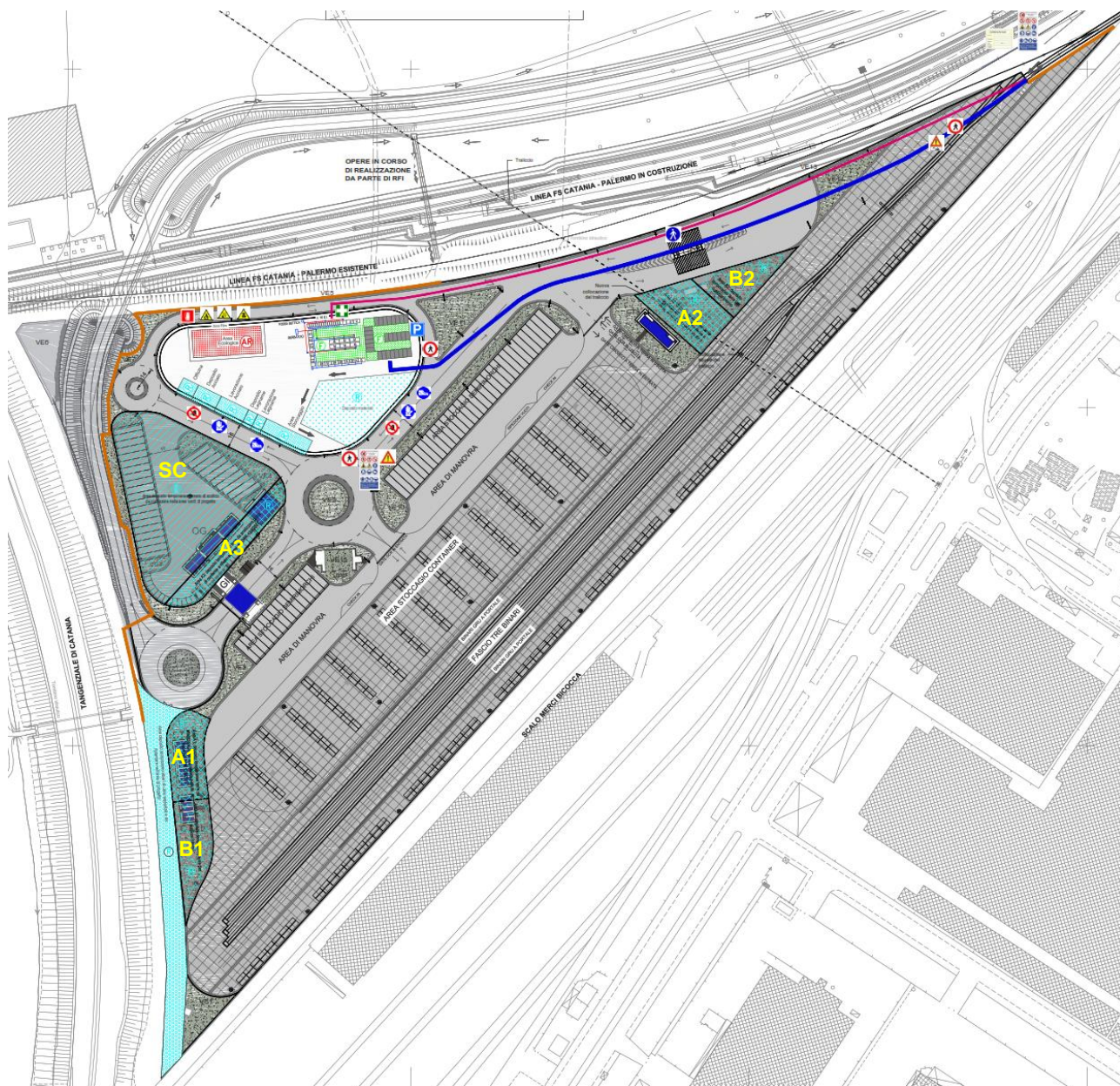
Figura 4 Stralcio dell’elaborato 00 03 02 “Apprestamenti di cantiere”, dove sono riportate, tra i vari elementi della cantierizzazione, le varie aree di stoccaggio terre.
