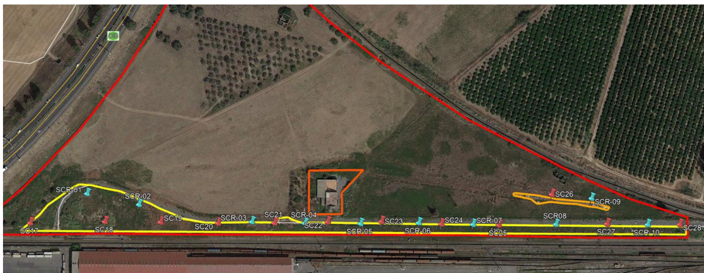
Figura 36 Ubicazione dei punti di indagine da effettuare in corso d'opera dopo la rimozione dei rifiuti e la BOB nelle due aree con presenza di cumuli di rifiuti (Area 1 in giallo e Area 2 in arancione chiaro); in rosso i punti già previsti per le indagini ante operam, ma non eseguite, mentre in azzurro i punti proposti per il corso d'opera.
