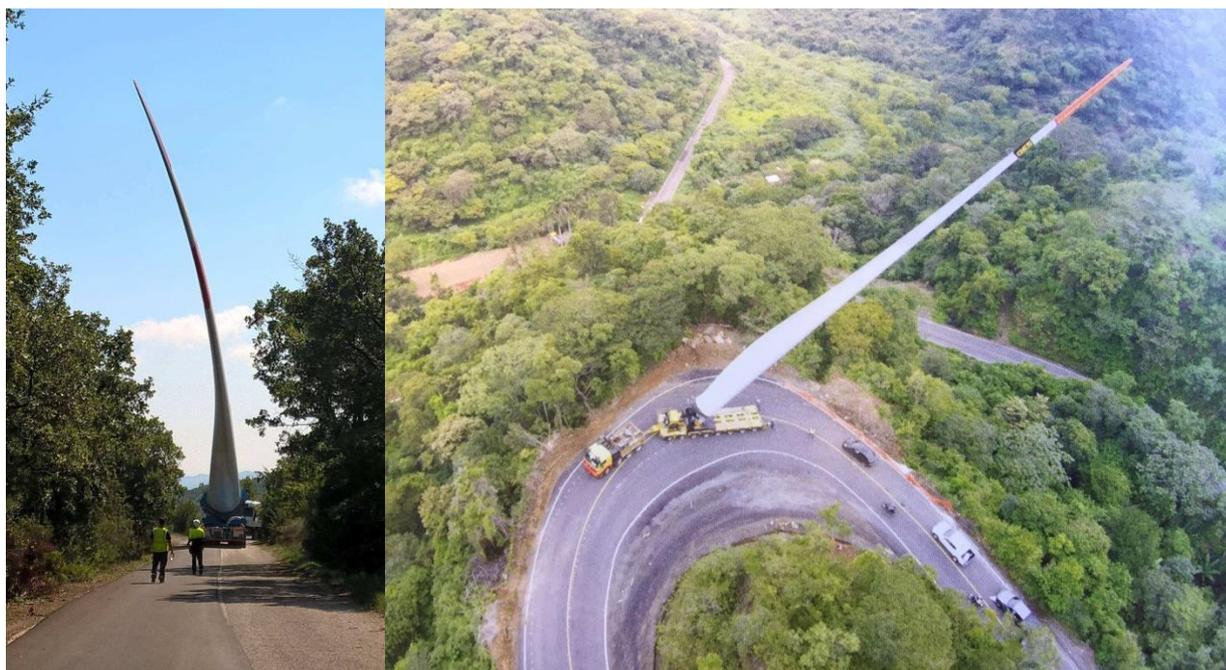
**Figura 9** Esempi di Blade lifter trailer
