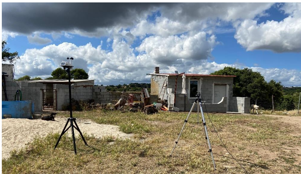
Figura 11: Dettaglio posizione microfono e centralina meteo
