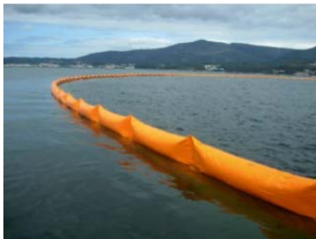
Figura 13: Esempio di utilizzo di barriera galleggiante antinquinamento (Immagini di proprietà di CSA Distribuzione srl)
