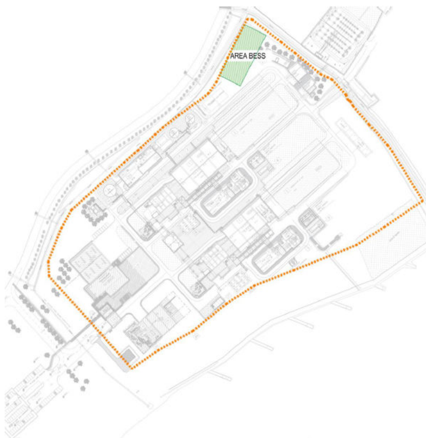
Fig.1 Ubicazione del sistema di accumulo di energia
