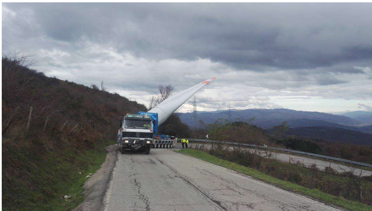
Fig. 8 : mezzo trasporto eccezionale speciale pala (blade lifter)
