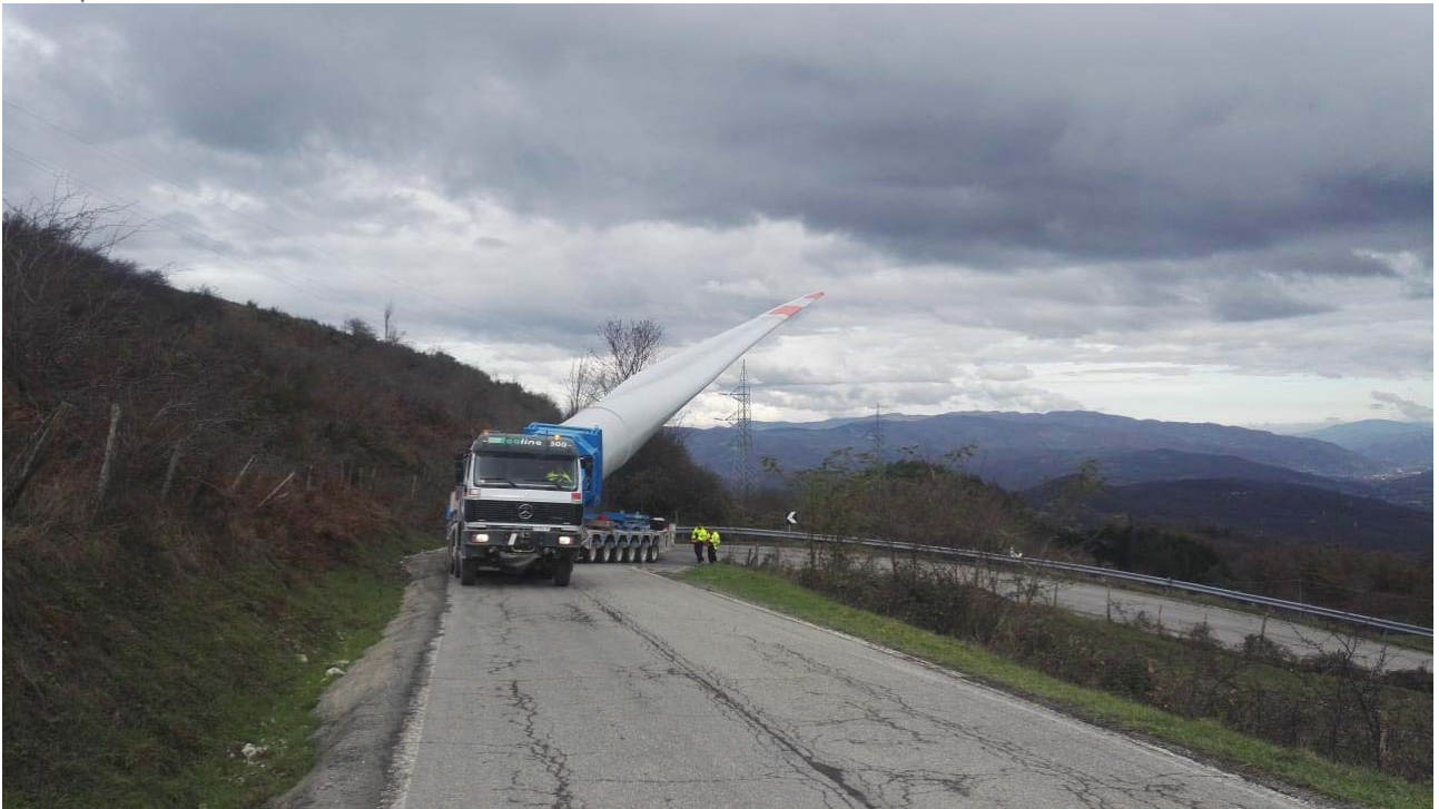
Fig. 8 : mezzo trasporto eccezionale speciale pala (blade lifter)
