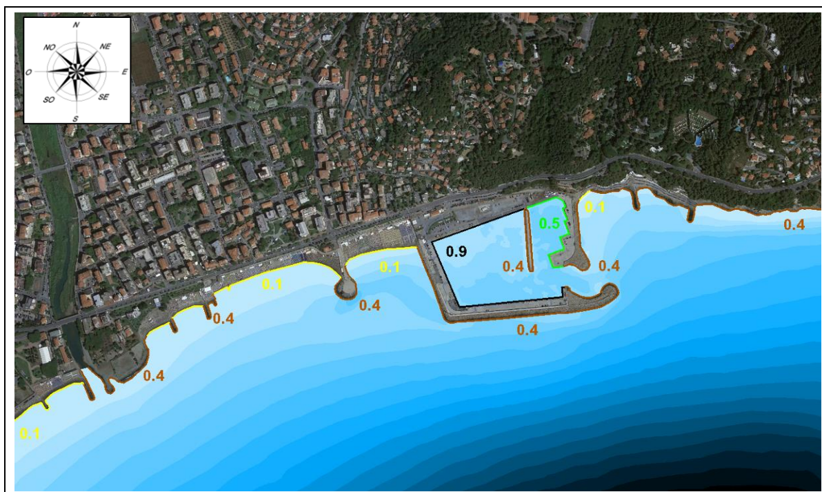
Fig. 6.6 – Coefficienti di riflessione impiegati nello studio dell'agitazione ondosa
