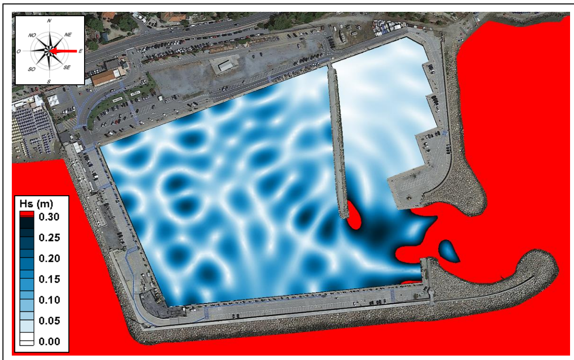
Fig. 6.22 – TEST 5: mareggiata estrema di Levante, verifica delle condizioni “di sicurezza”
