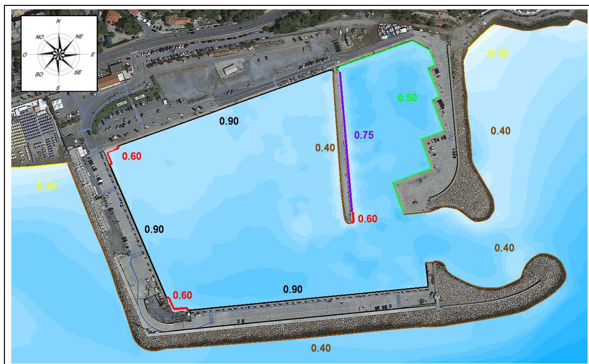
Fig. 8.2 – Coefficienti di riflessione impiegati per lo studio dell'agitazione ondosa nella configurazione di progetto
