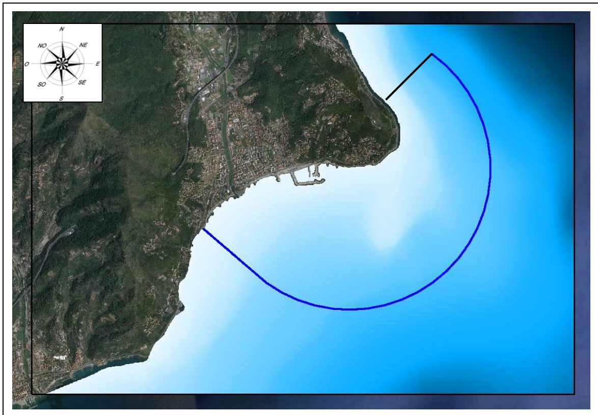
Fig. 6.4 – Griglia STWAVE e bordo offshore del dominio CGWAVE
