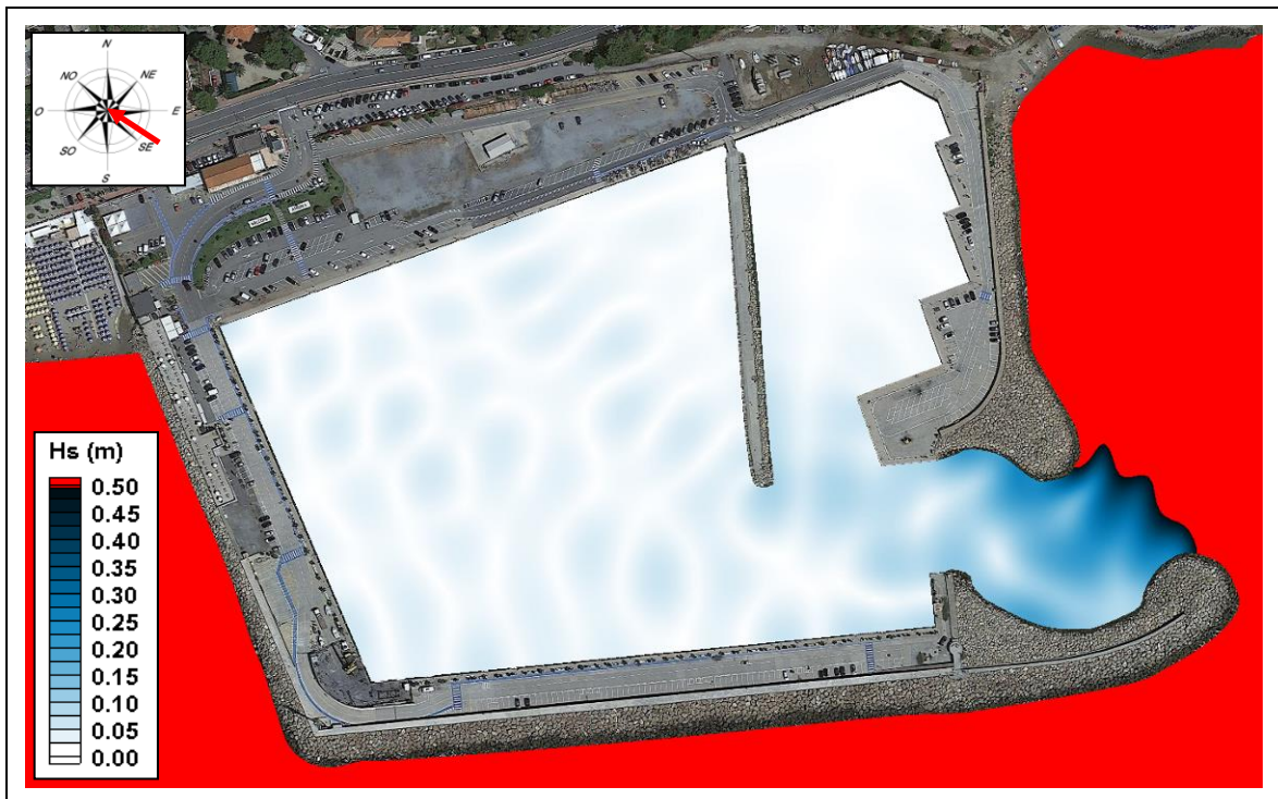
Fig. 6.14 – TEST 9: mareggiata estrema T_R = 50 anni di Levante-Scirocco, verifica delle condizioni "limite"
