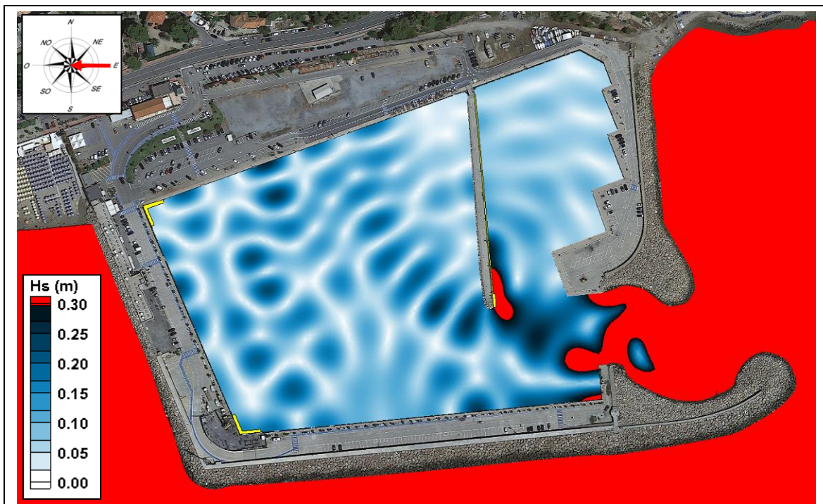
Fig. 8.8 – TEST 5: mareggiata estrema di Levante, verifica delle condizioni “di sicurezza”
