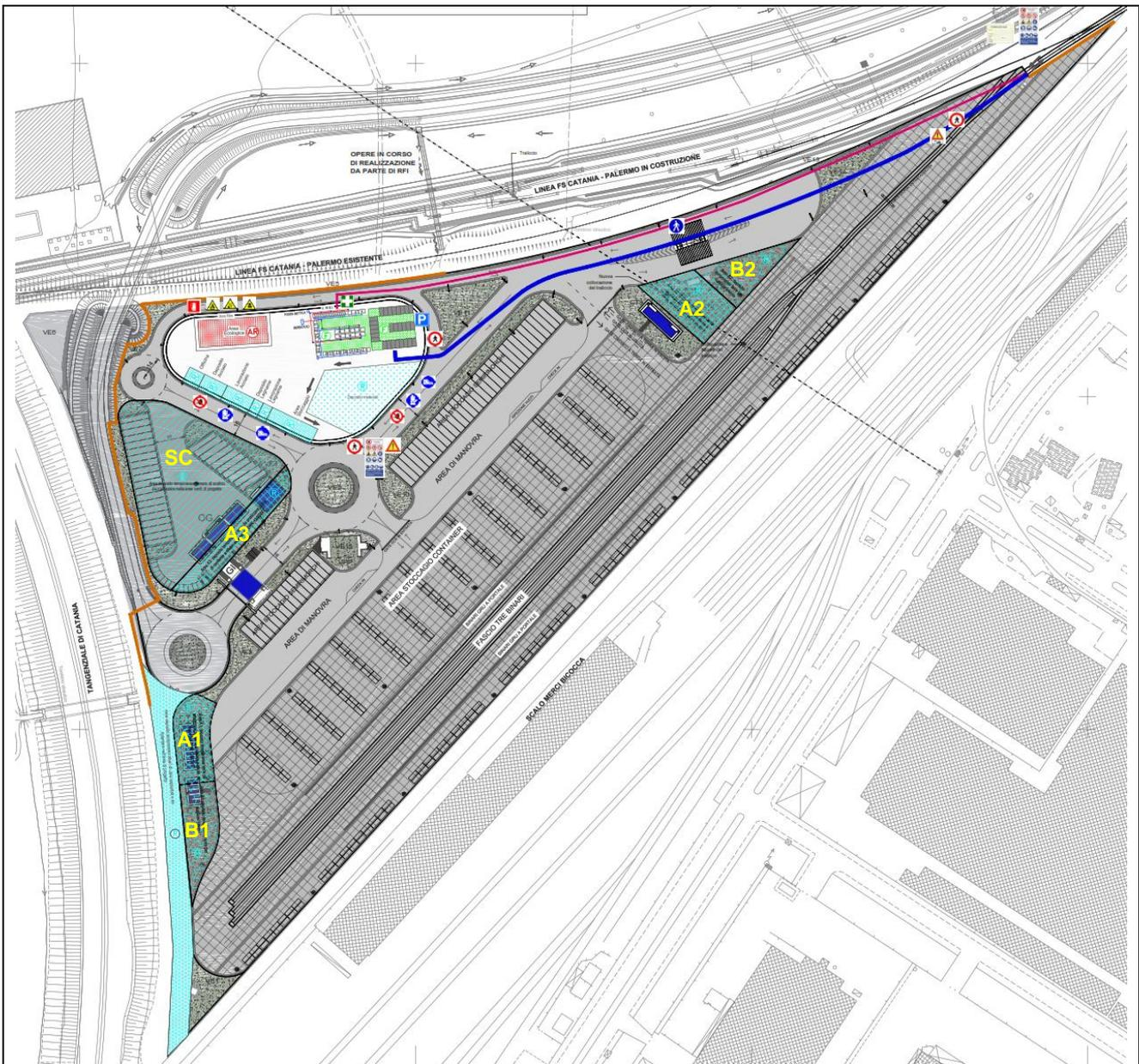
Figura 10 Stralcio dell'elaborato 00 03 02 "Apprestamenti di cantiere", dove sono riportate, tra i vari elementi della cantierizzazione, le varie aree di stoccaggio terre.
