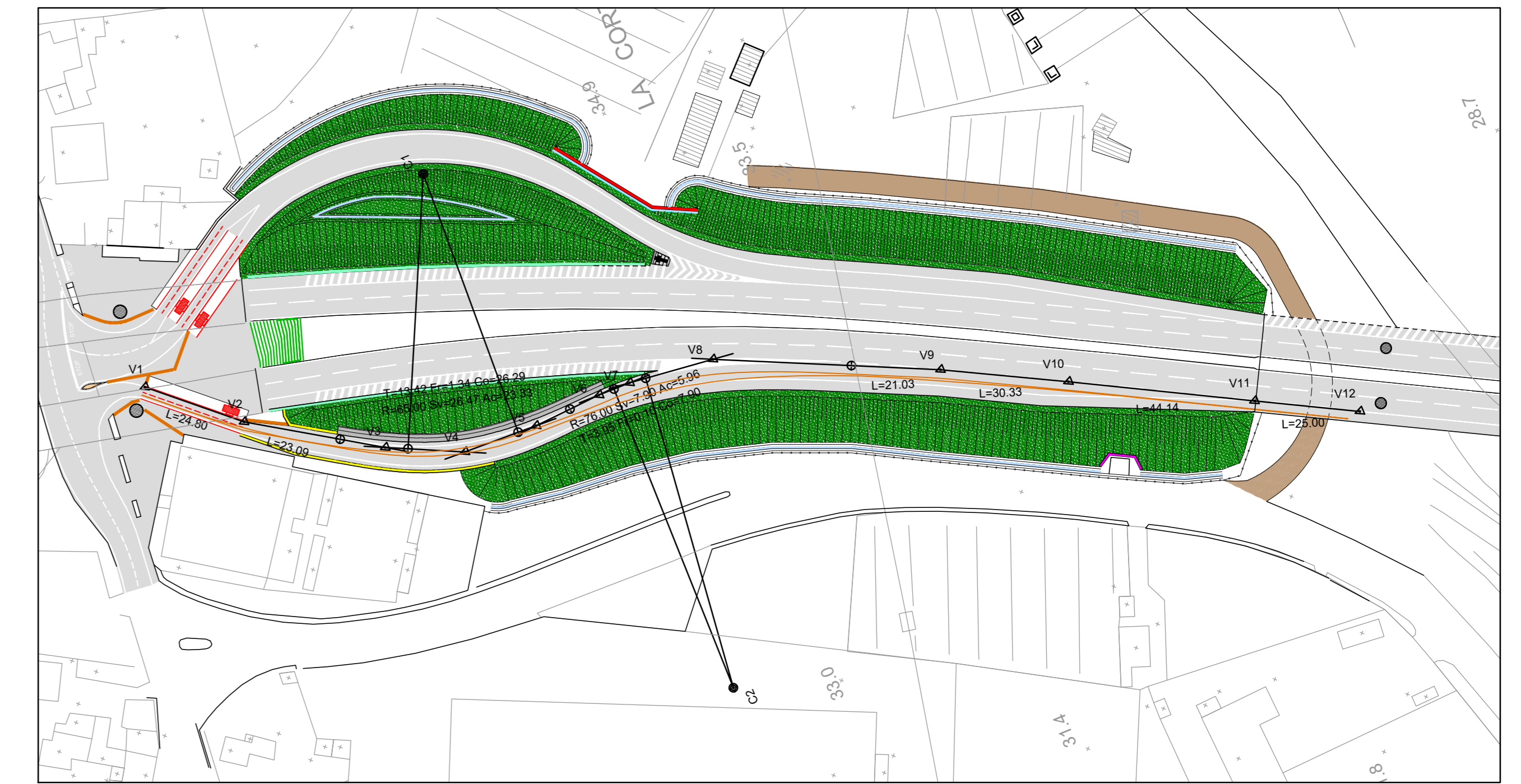
PLANIMETRIA DI TRACCIAMENTO RAMPA DI IMMISSIONE SCALA 1:1000
