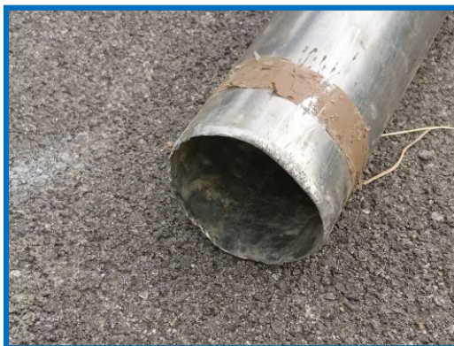
Foto 6.1 – Il campionatore Shelby danneggiato per i tentativi di prelevare un campione di terreno.
