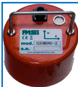
Fig. 6.6 - Geofono triassiale Gemini 2 utilizzato per le misure
