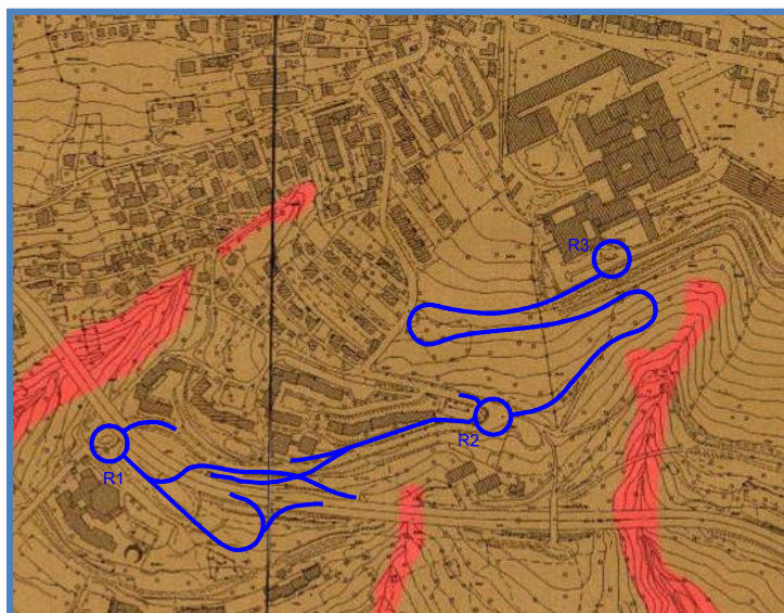
Fig. 3.1 – Stralcio della Carta della Zonizzazione geologico-tecnica (GZ-Tav. 7). In rosso sono evidenziate le zone non edificabili ZG1, in corrispondenza degli alvei dei rii (da W a E) Spinoletto, Marcese e Storto; le altre zone sono ZG6, edificabili. Le linee blu corrispondono al tracciato indicativo della strada.
