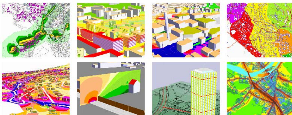
Figura 2-21 SoundPlan – esempio di output del modello in 2D e 3D della mappatura acustica
