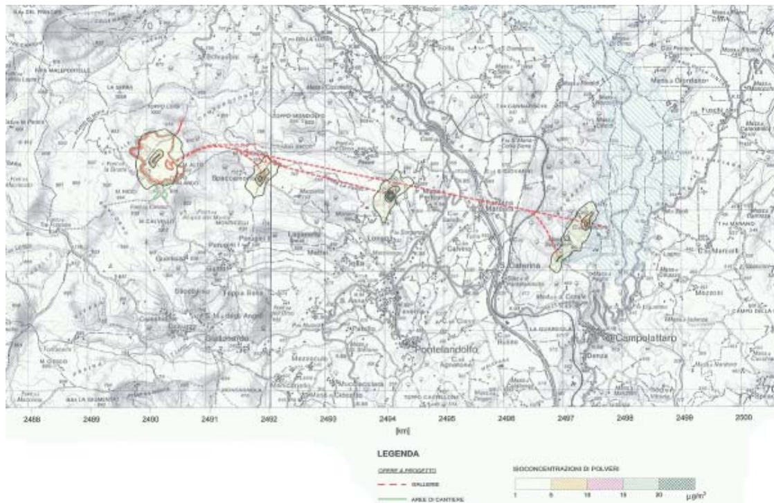
Figura 6.a: Stima delle Ricadute al Suolo di Polveri in Fase di Cantiere (Impianto Idroelettrico)
