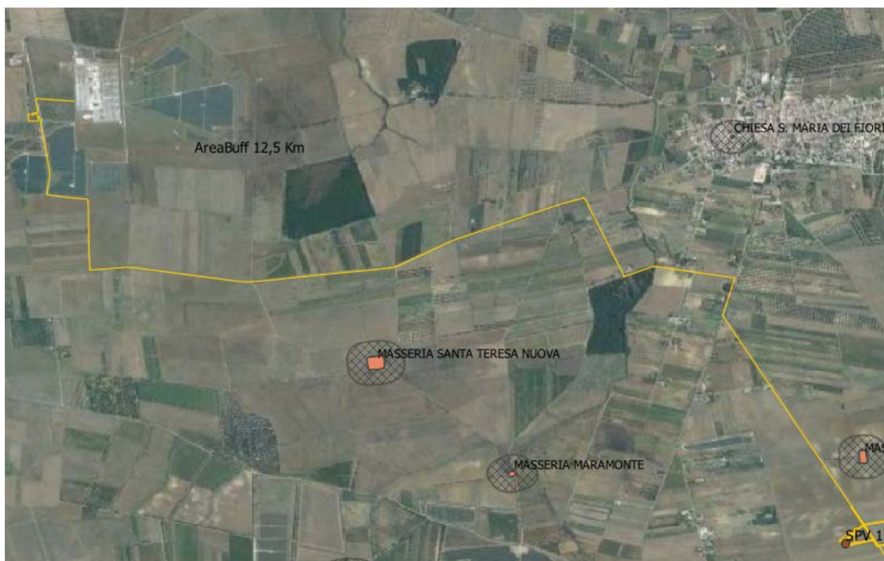
Figura 3. Il cavidotto dalla SPV 01 sino all'area della Stazione Elettrica BRINDISI CERRITO. (ortofoto - elaborazione QGIS)
