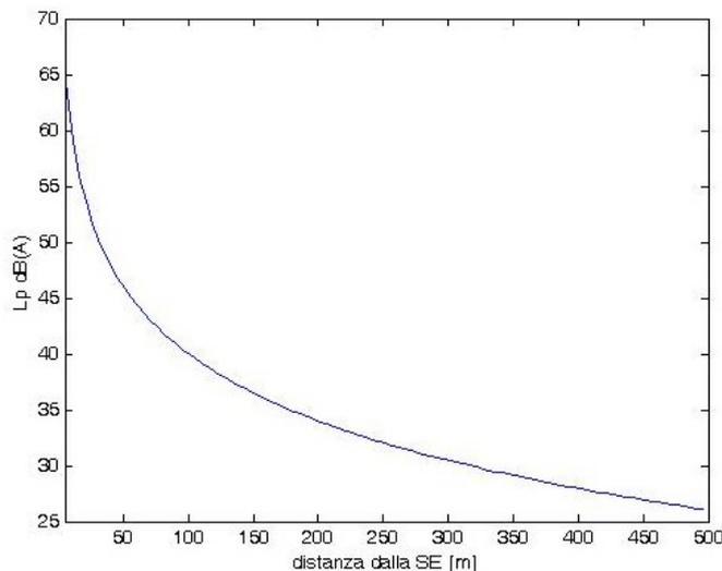
Di seguito, note le distanze dei ricettori dalla **SE** (Sorgente di Emissione) e le componenti dei livelli di pressione sonora, si determina l' $L_p$ (A) dovuto alle varie sorgenti di emissione presso il ricettore e in prossimità dell'aerogeneratore oggetto dell'intervento. La distanza minima del cantiere temporaneo rispetto al ricettore più vicino è pari a 320 metri, e di circa 50 dal cantiere mobile al ricettore più vicino.
