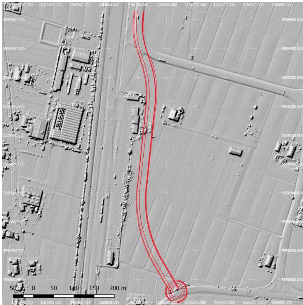
Fig. 10- Tracciato in progetto con sfondo base Lidar a maglia di 1m x 1m che evidenzia le forme morfologiche di dettaglio del terreno
