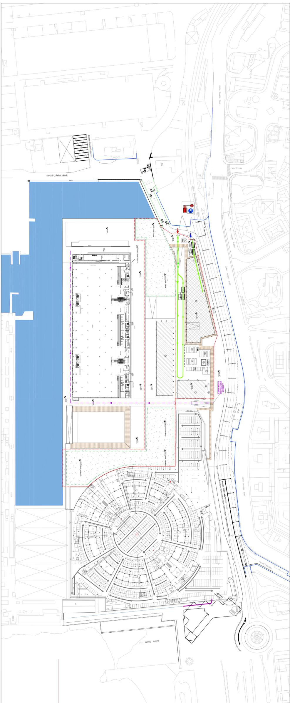
LAYOUT DI CANTIERE REALIZZAZIONE CANALI - FASE FINALE - Scala 1:1000
