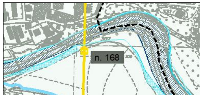
Figura 4.4.2/5 – Attraversamento del Fiume Dora Riparia. Non sono presenti sostegni all'interno delle fasce fluviali
