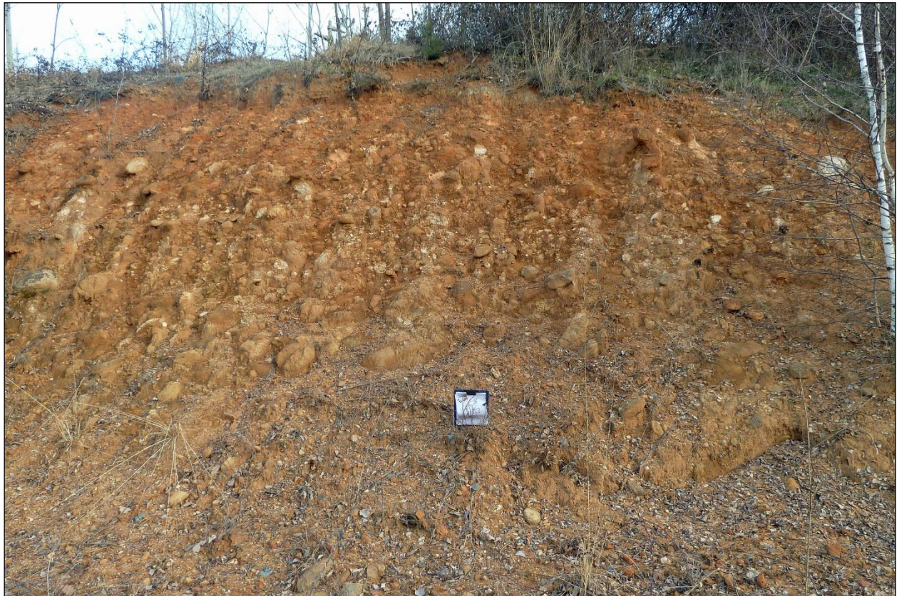
Figura 3.5.4/5 – Zona campeggio presso il Campo Sportivo – Il foglio A4 (al centro) dà la misura della granulometria del substrato detritico con frammenti litici, mediamente alterati, che arrivano a circa 35 cm di diametro – Zona nuovi sostegni n. 97 e 98
