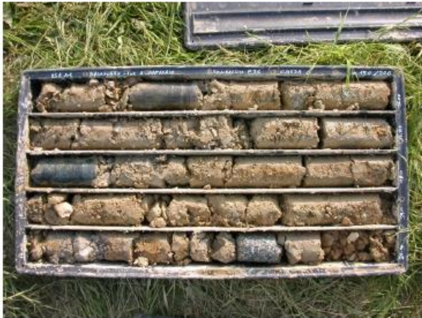
Foto 4: Sondaggio P34 - cassa 4 - da 15.00 m a 20.00 m.
