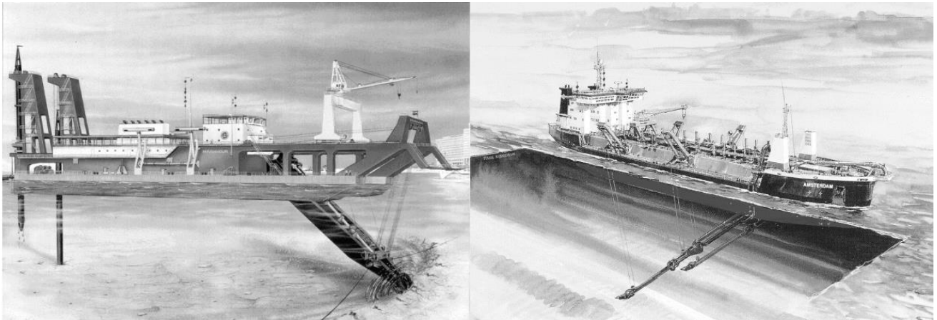
Figura 86 – Draga aspirante refluyente stazionaria (CSD, a sinistra) e autocaricante (TSHD, a destra)
