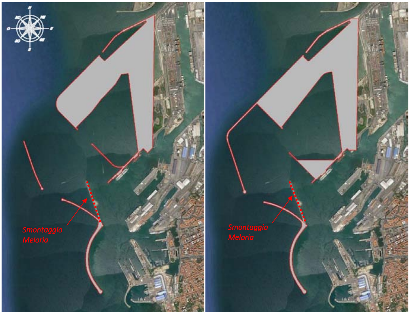
Figura 117 – Layout di prima fase previsto dal P.R.P. e layout prima fase proposto dal R.T.P.(con chiusura diga Nord)
