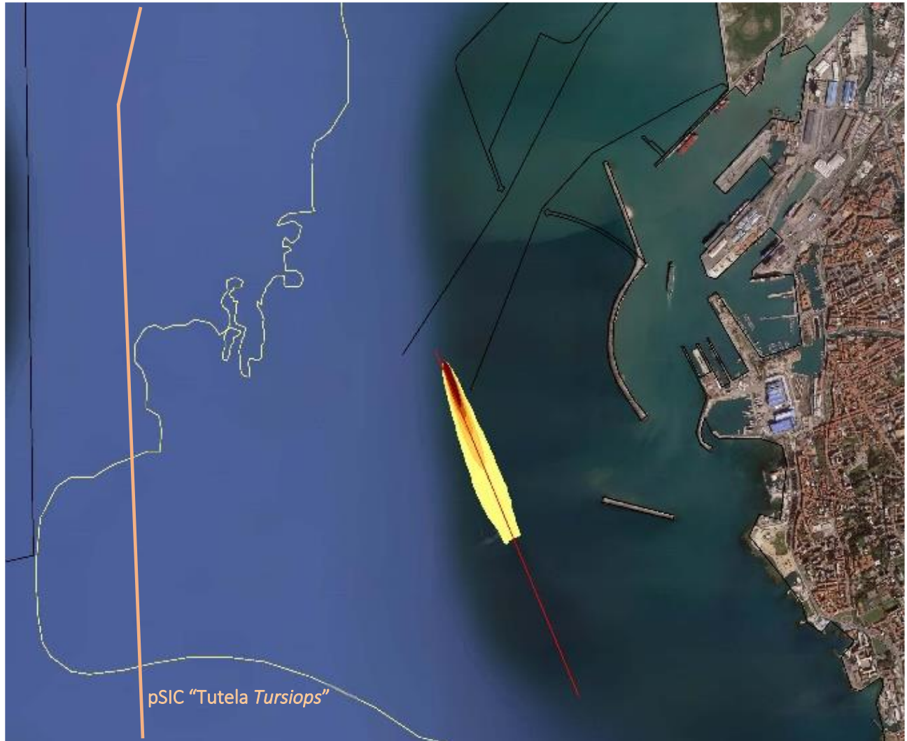
Figura 173 - Corrente diretta verso Sud, dragaggio del canale di ingresso con draga CSD involuppo della massima concentrazione di sedimenti in sospensione (planimetria)
