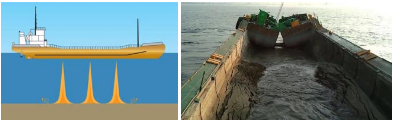
Figura 161 – Versamento con motopontone a fondo apribile (a sinistra) e split-barge (a destra)
