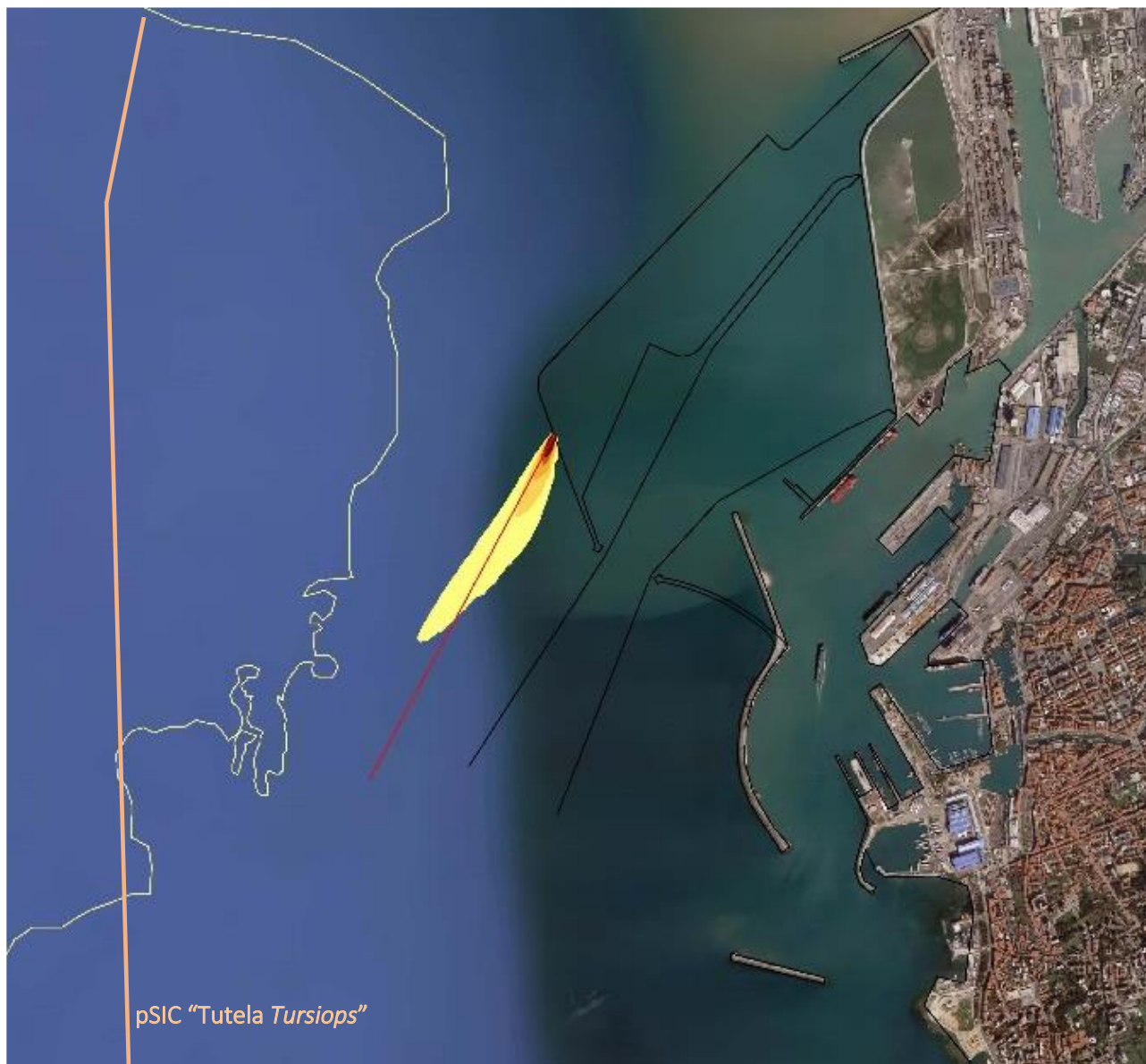
Figura 167 - Vento di Grecale, scavo di imbasamento delle opere foranee; involuppo della massima concentrazione di sedimenti in sospensione (planimetria)
