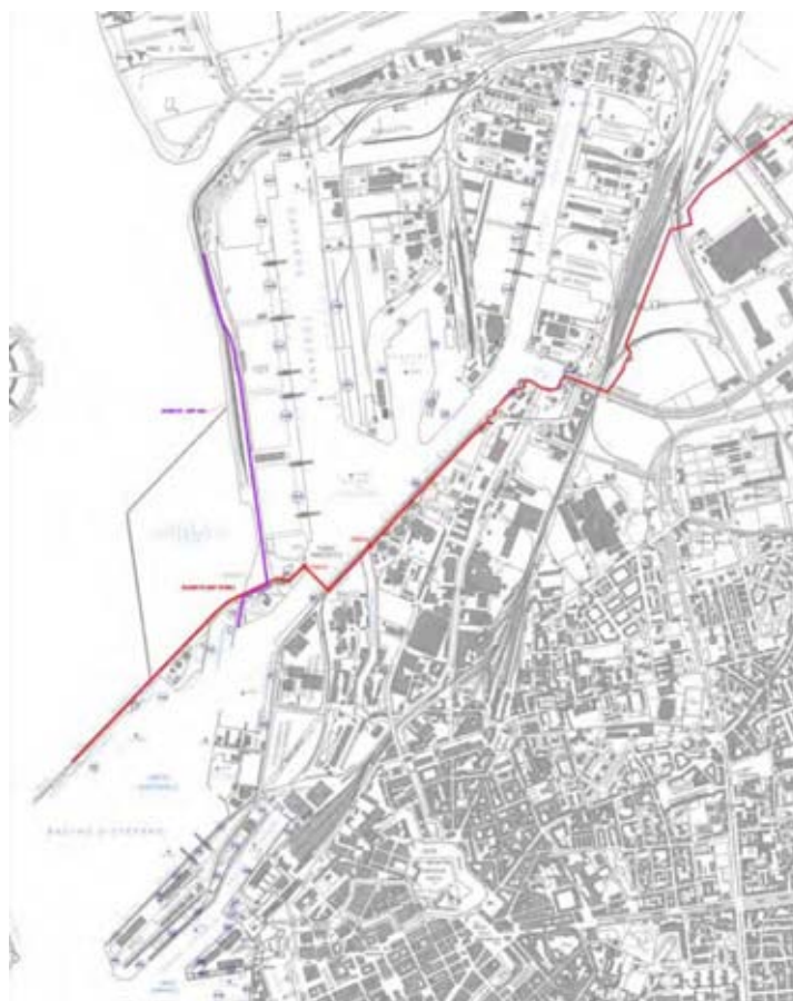
Figura 150: Tracciato delle condotte
