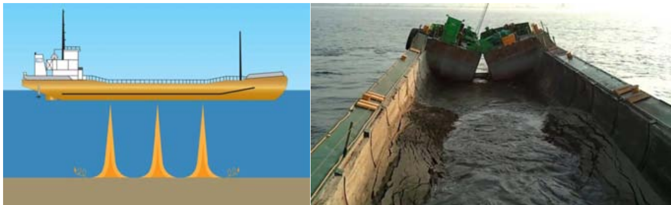
Figura 90 – Operazione di scarico da motopontone a fondo apribile (a sinistra) e split barge (a destra)
