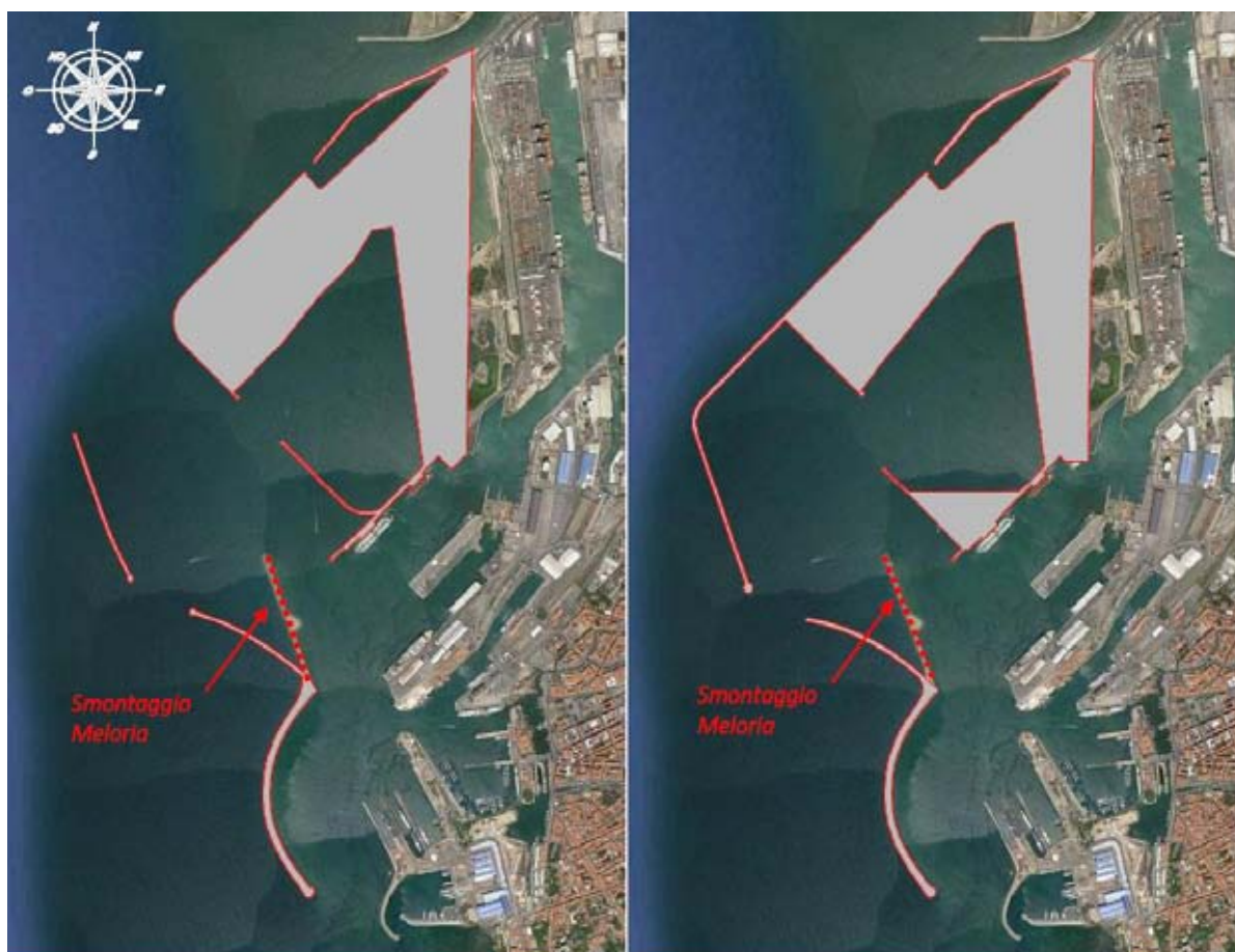
Figura 63: Layout di prima fase previsto dal P.R.P. e layout prima fase proposto dal R.T.P.(con chiusura diga Nord)
