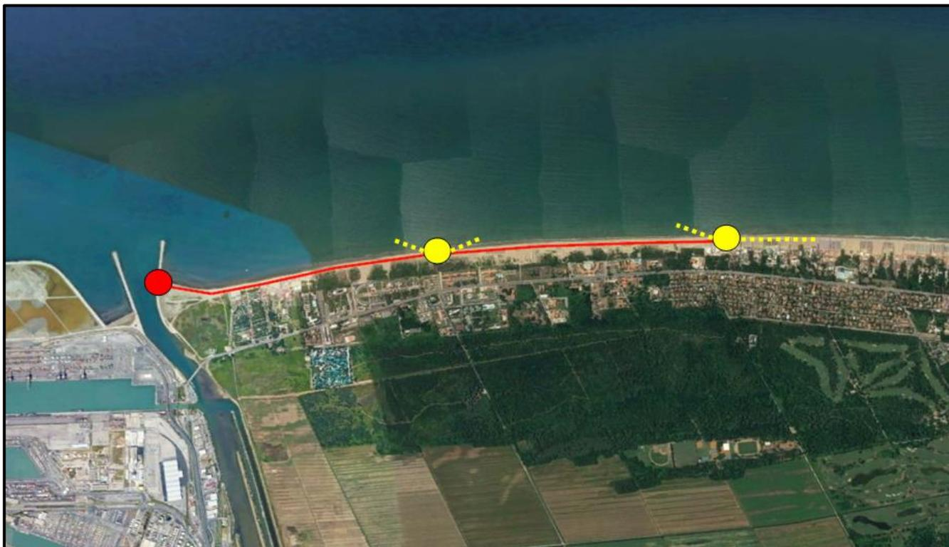
Figura 5.3 – Ipotesi di Tracciato del sabbiodotto con punto di collegamento alla draga (rosso) e punti di scarico (giallo)
