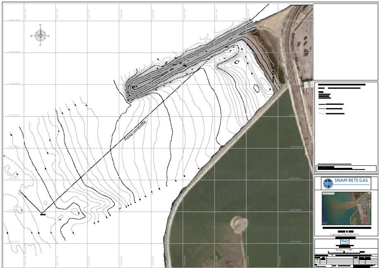
Figura 3.3 – Carta planobatimetrica dell'area e tracciato della condotta
