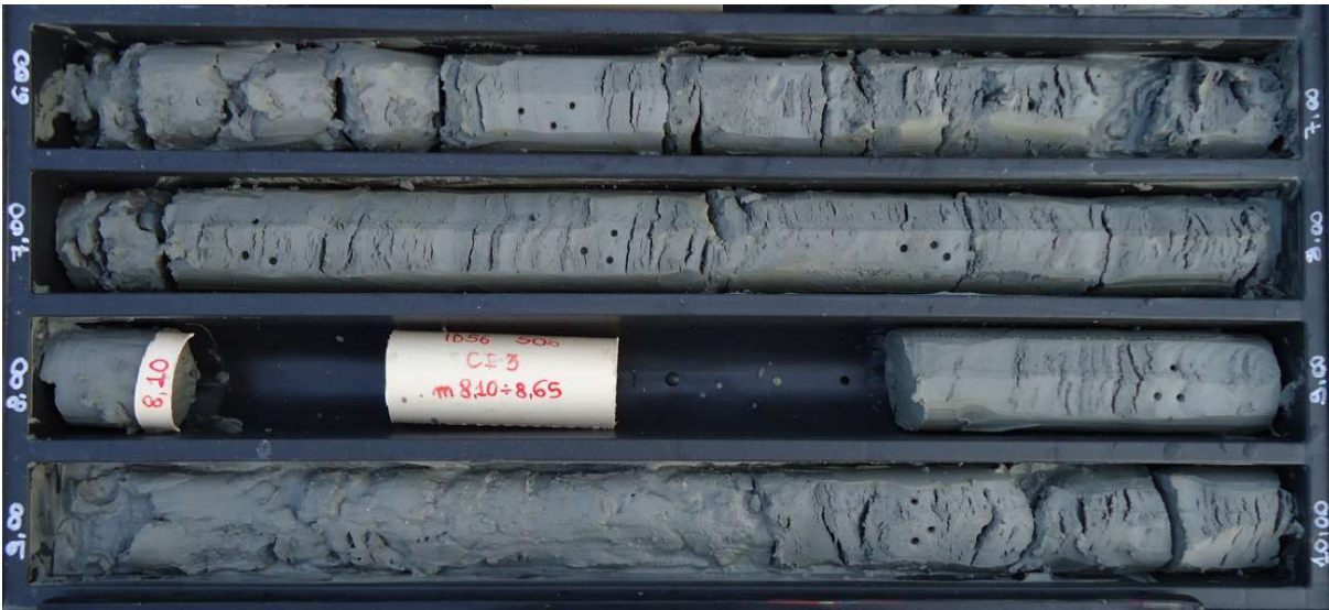
Figura 19: Sondaggio ID56-S06, da 6 a 10 m in cassetta; argilla limosa con intercalazioni di sabbia fine, grigia
