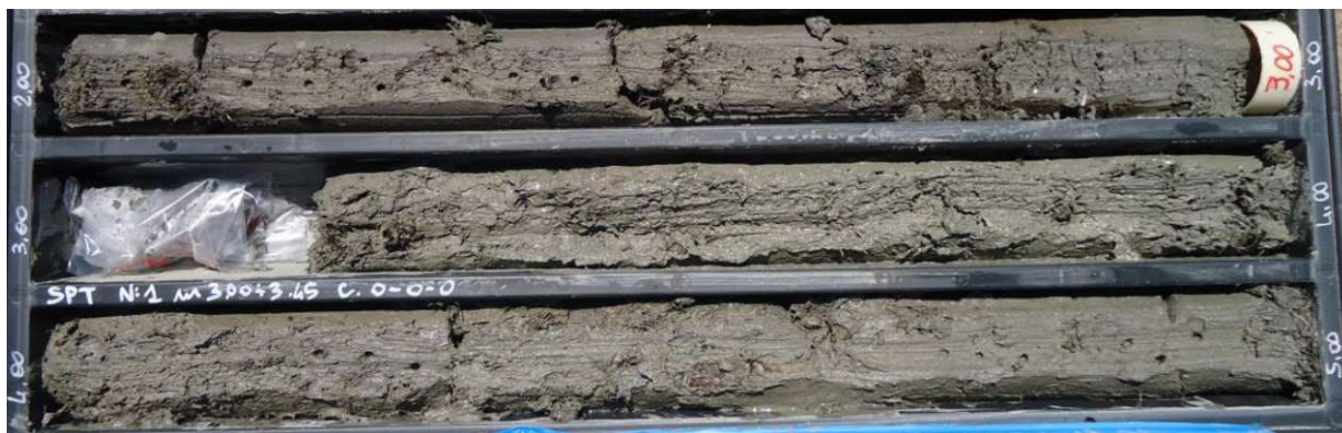
Figura 14: Sondaggio ID02-S02, da 2 a 5 m in cassetta; esempio di facies con resti di fanerogame di posidonia oceanica
