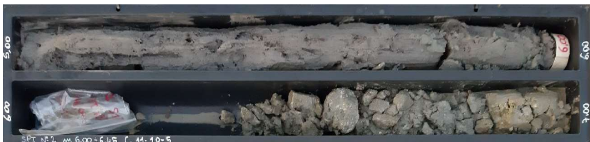
Figura 15: Sondaggio ID26-S17, da 5 a 7 m in cassetta; calcarenite semi-litoide e contatto con l'Orizzonte superiore al tetto
