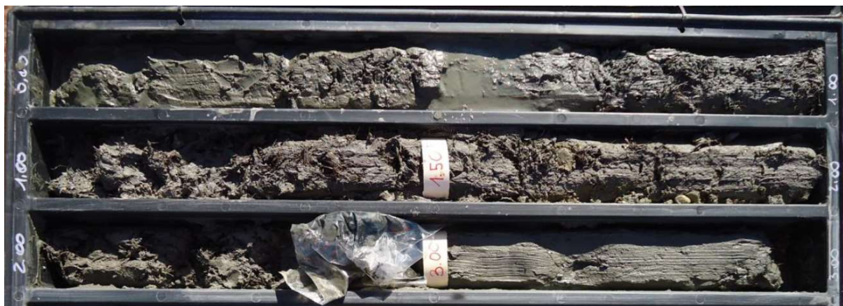
Figura 13: Sondaggio ID10-S08, da 0 a 2 m in cassetta; esempio di facies con elementi di ghiaia e resti di posidonia
