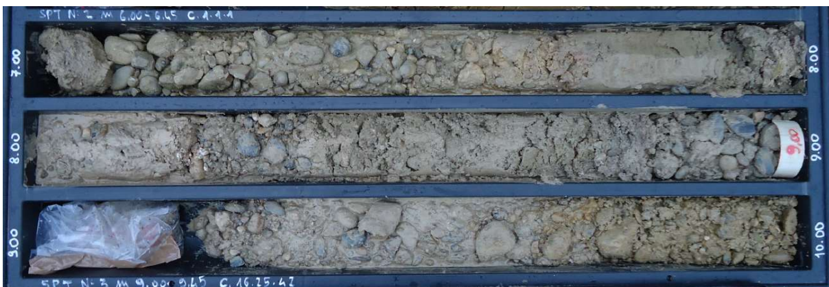
Figura 18: Sondaggio ID09-S07, da 7 a 10 m in cassetta; alternanze di ghiaia medio-grossa e sabbia medio-fine limosa, color avana
