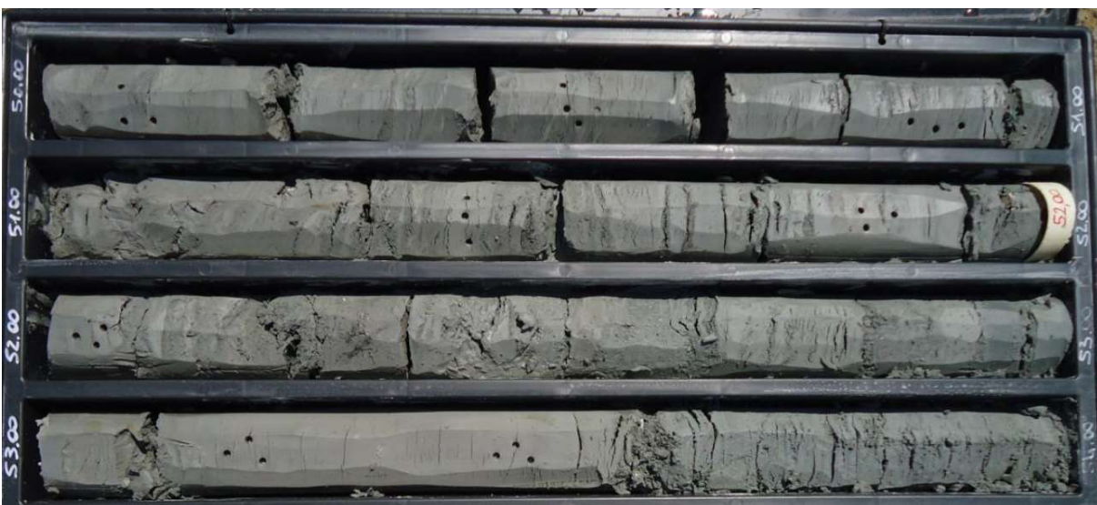
Figura 20: Sondaggio ID01-S01, da 50 a 54 m in cassetta; argilla sabbiosa fine, grigia
