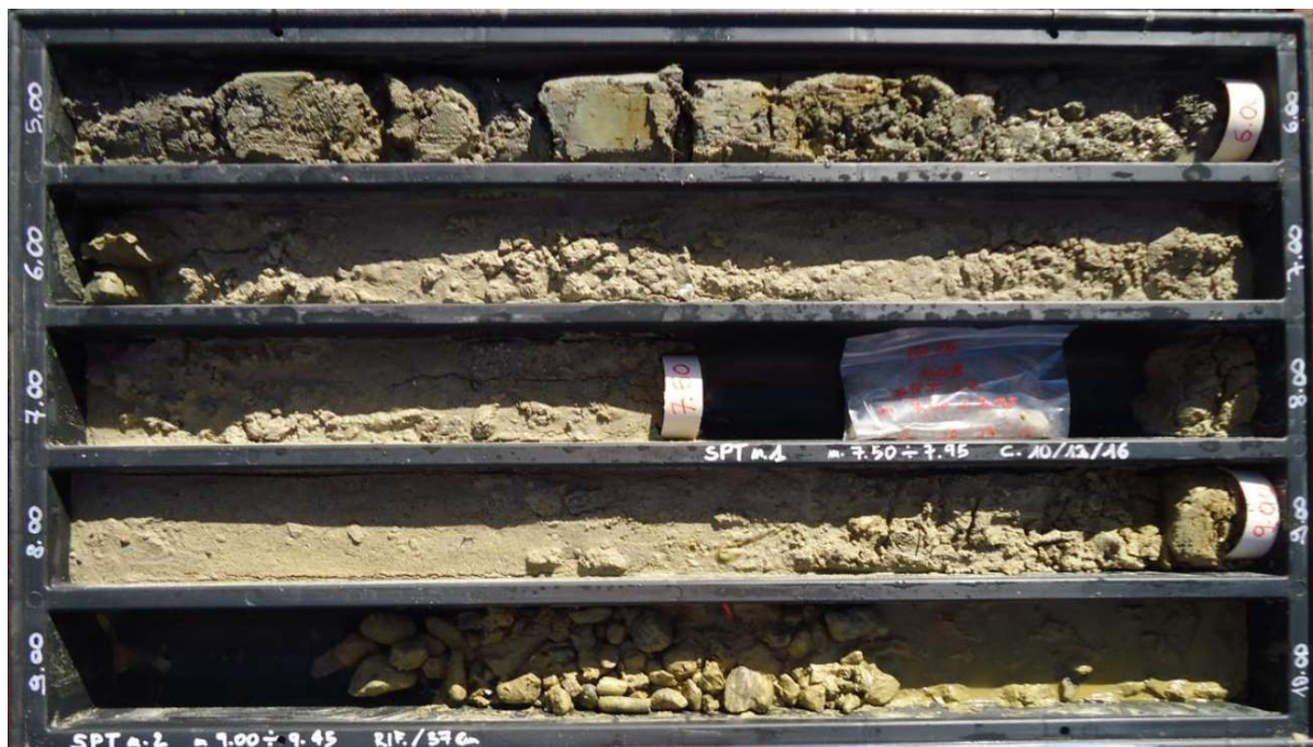
Figura 16: Sondaggio ID10-S08, da 5 a 10 m in cassetta; sabbia fine con clasti calcarenitici (color nocciola/ocra/avana)
