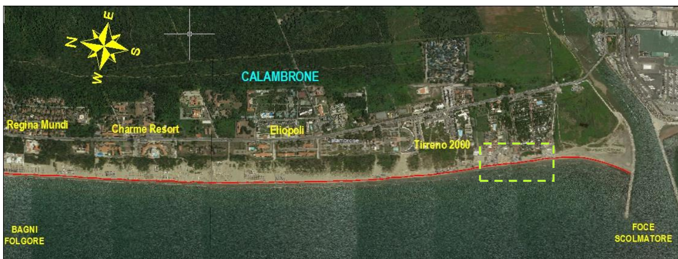
Figura 3.30 - Limite superiore della fascia di battigia rilevato nel tratto di litorale di Calambrone
