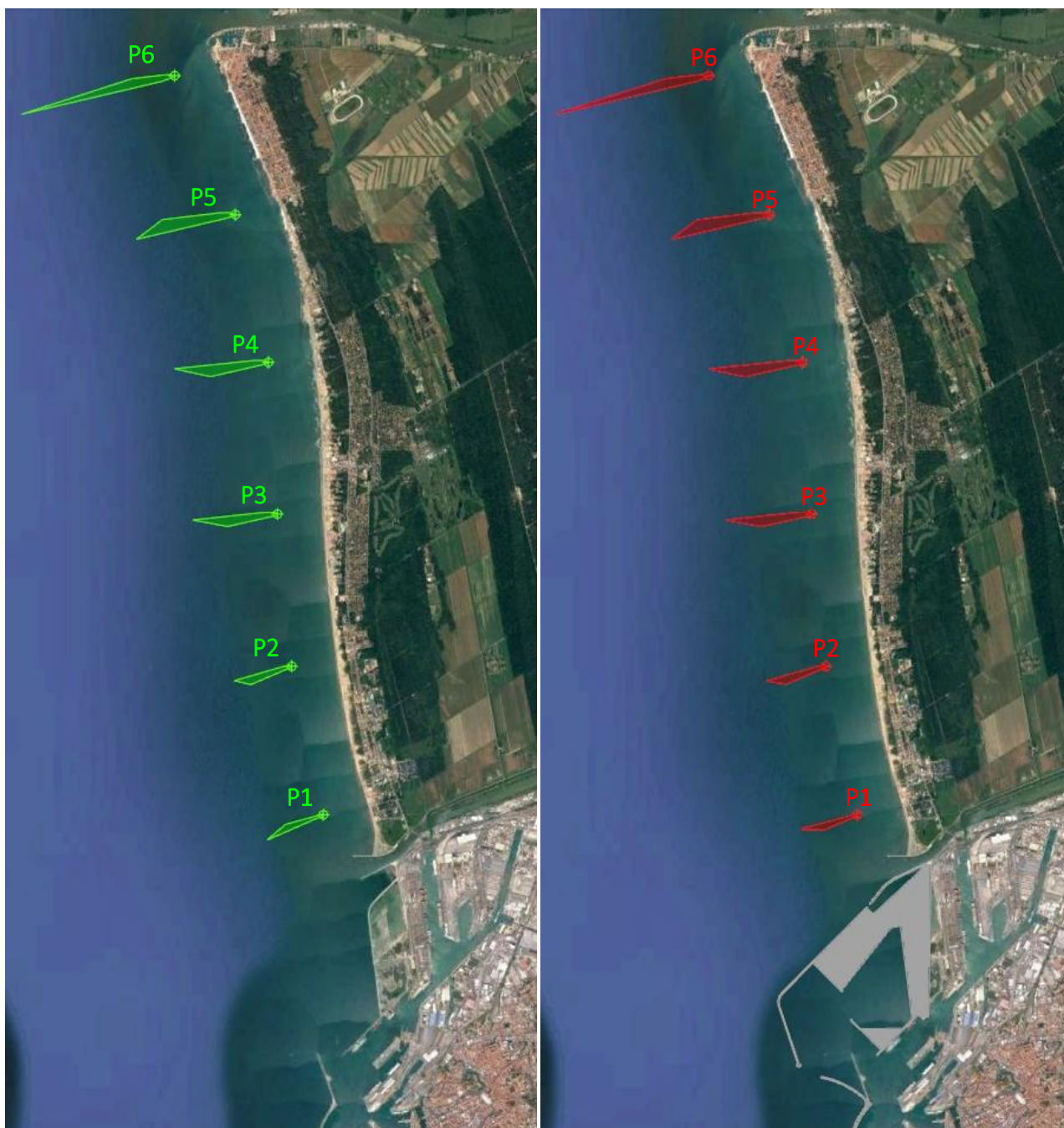
Figura 4.2 – Rose delle energie per i 6 punti sottocosta con riferimento a: configurazione attuale del porto (a sinistra in verde) e di progetto (a destra in rosso)
