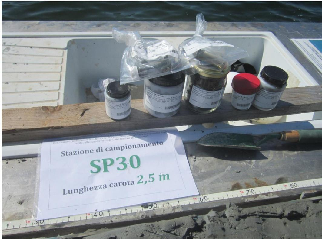
Figura 9. Configurazione tipica delle aliquote prelevate per ciascuna sezione di carota
