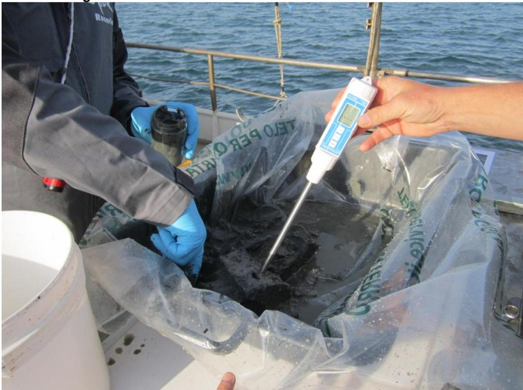
**Figura 14. Misure da campo della temperatura sul campione "fresco" tal quale appena prelevato**
