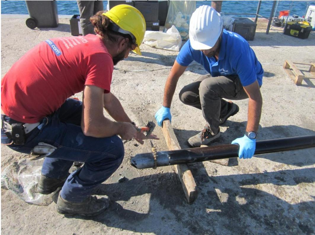
Figura 10. Dettaglio della modalità di apertura del "naso trappola" del vibrocarotiere
