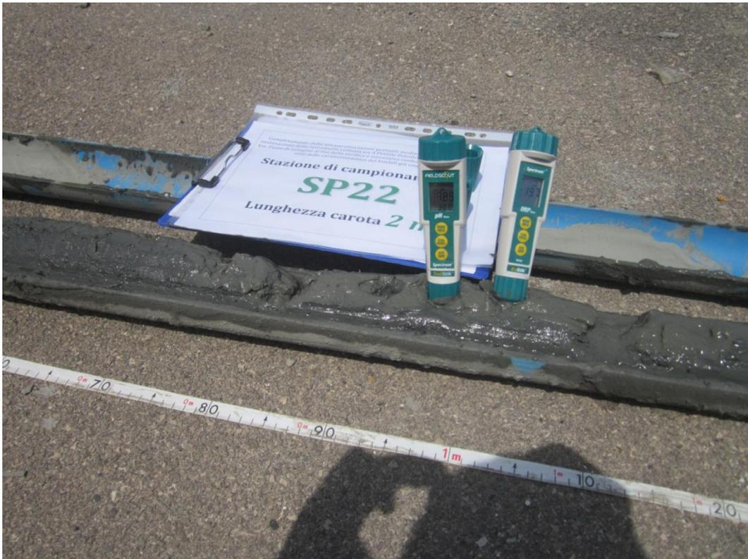
Figura 15. Misure da campo (pH e Redox) sul campione "fresco" tal quale appena prelevato
