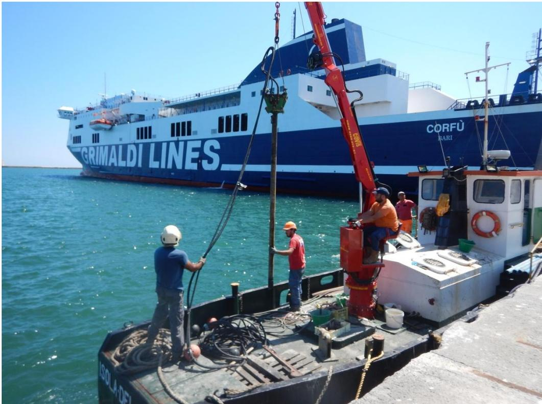
**Figura 5. Imbarcazione "Isola del Giglio" impiegata per le operazioni di campionamento e gestione del vibrocorer**
