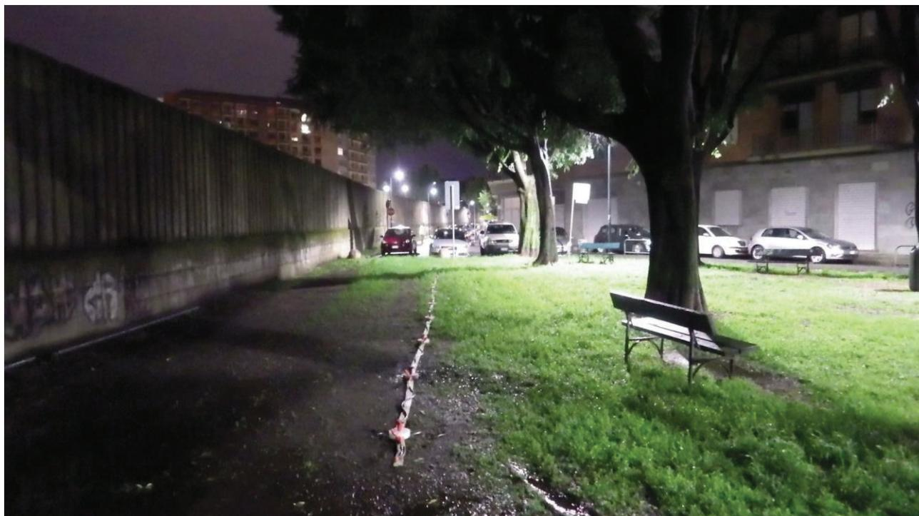
Figura 2. Acquisizione notturna con Land Streamer nel settore terminale della sezione 2D.
