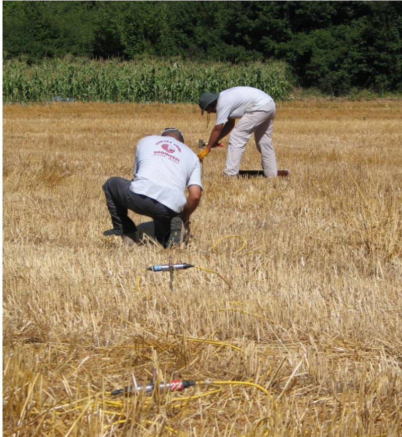
Figura 4 - Fase di “layout” dei profili di tomografia elettrica
