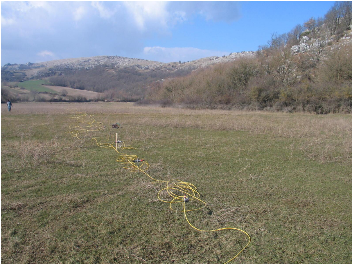
Figura 4 – Fase di “layout” dei profili di tomografia elettrica
