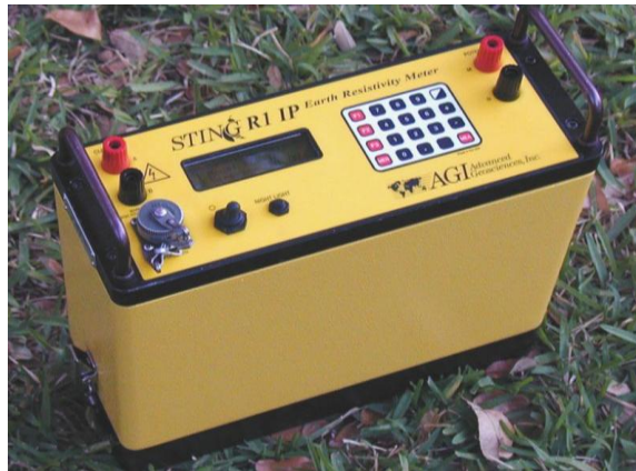
Figura 2 - Resistivimetro “STING R1/IP”
