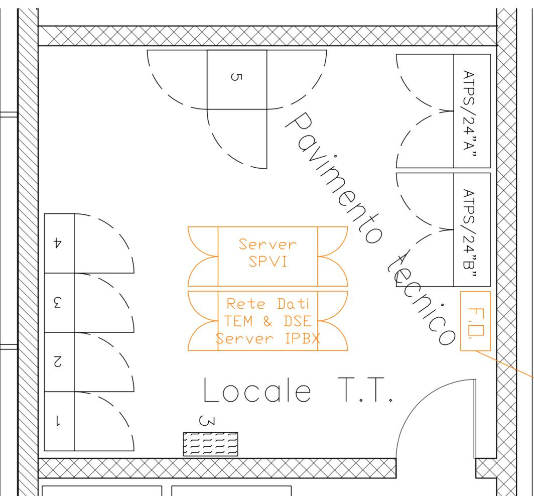
NOTA: i nuovi cavi/apparati SG saranno ubicati nei medesimi telai/armadi del sistema esistente evidenziati nel layout
