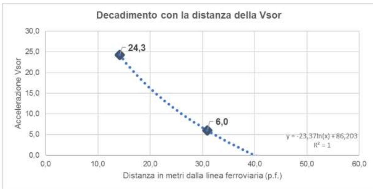
Figura 5-3 Curva di attenuazione della V SOR ricavata dai rilievi in corrispondenza delle terne T2 e T3 poste rispettivamente a 14,2 m e 30,9 m dal p.f. considerando treni regionali e A/V
