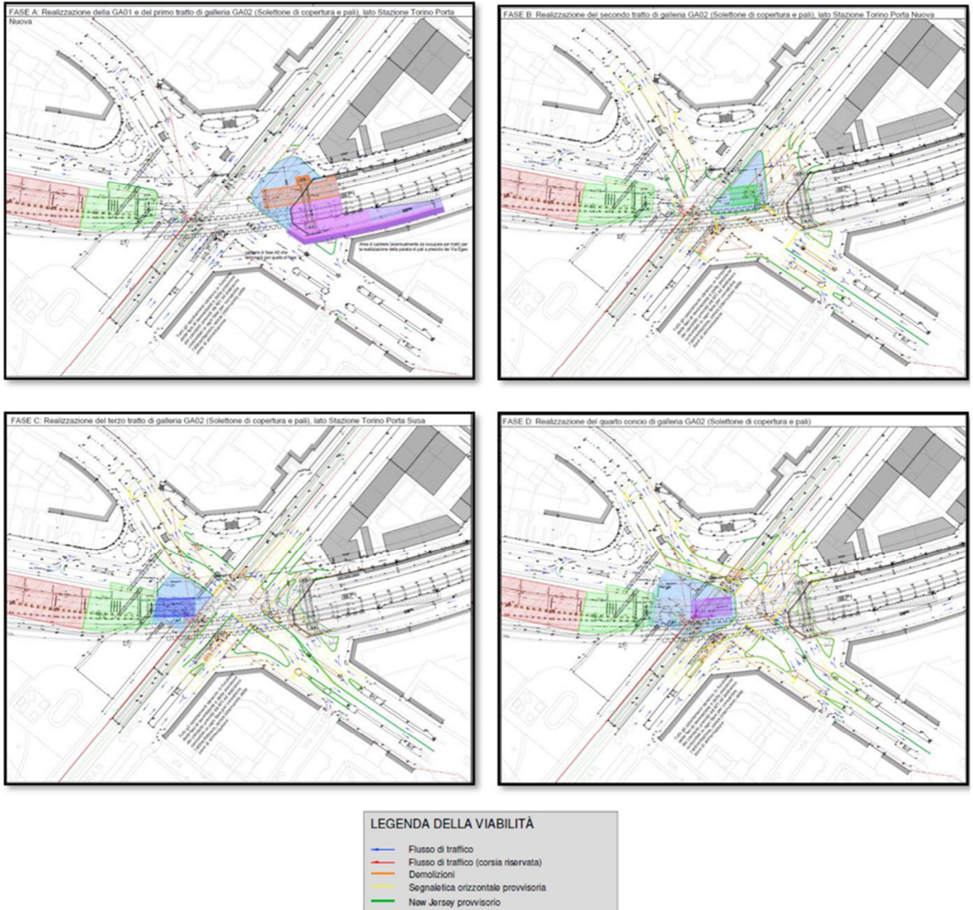
Figura 13 Fasi di realizzazione del tratto in galleria
