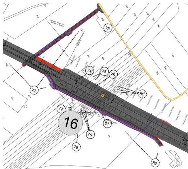
Ricucitura viabilità N10 e N12 – Le maggiori aree di esproprio colorate ed evidenziate con i numeri. In grigio l'esproprio di progetto definitivo. Per un miglior dettaglio si veda elaborato IF1L00E43BDAQ0000106A allegato
