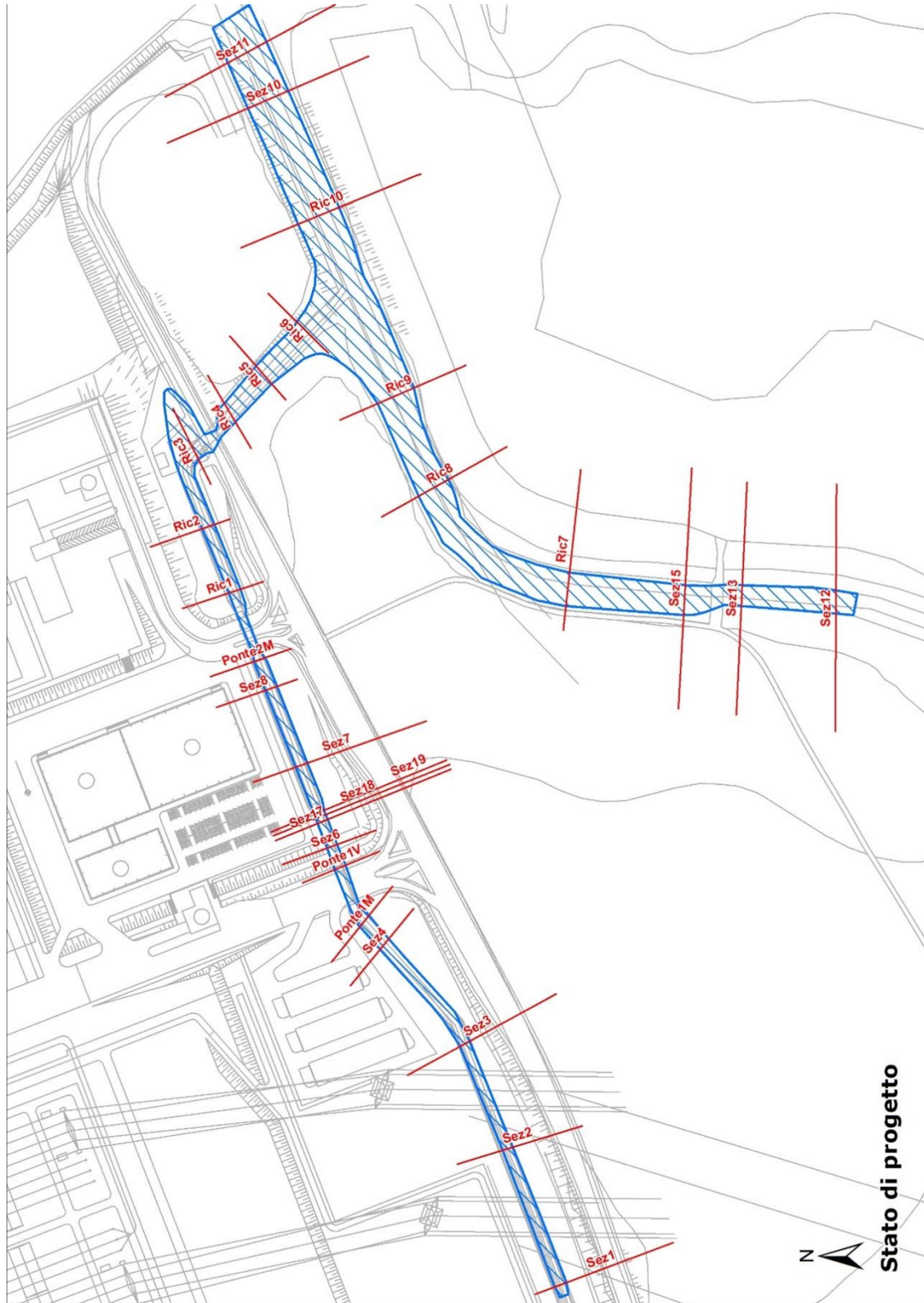
Figura 18: Aree di Esondazione nei pressi della centrale con layout nella futura configurazione progettuale
