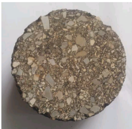
Figura 2 – Sezione di un provino cilindrico di base riciclata a freddo con emulsione
