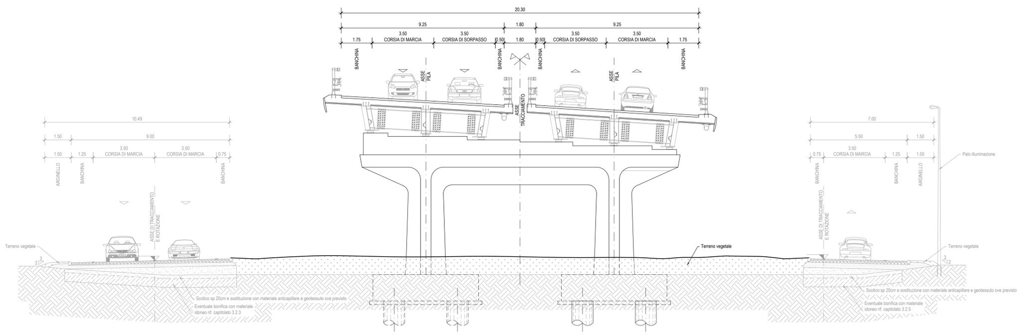
**SEZIONE TIPO IN VIADOTTO TRE PILE** scala 1:100
