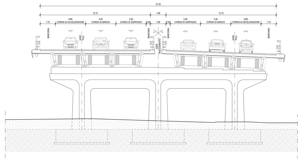
**SEZIONE TIPO CAVALCAVIA DI SVINCOLO S.S. 131** scala 1:100
