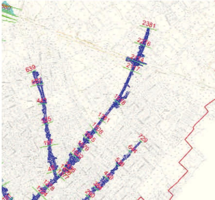
Figura 8 - Schema planimetrico dell'asse del Rio Selargius e delle sezioni trasversali
