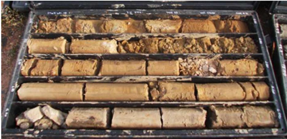
Figura 8. Arenarie di Pirri carotate nel sondaggio S1 tra 0 e 5 m di profondità.
