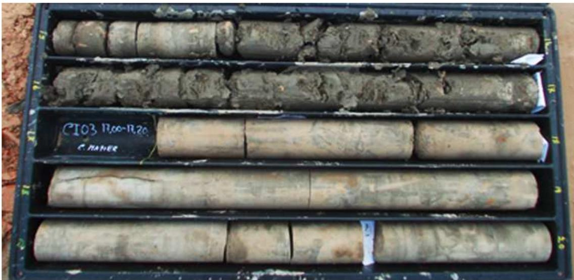
Figura 5. Marne di Gesturi (sondaggio S48 tra 15 e 20 m) è possibile osservare il passaggio dalla facies argilloso-marnosa a quella marnosa compatta.
