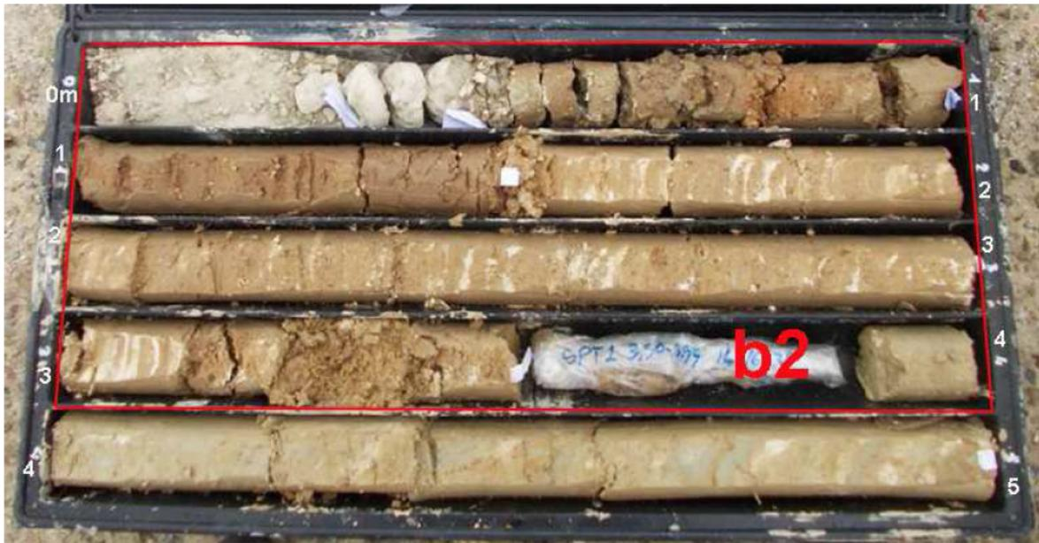
Figura 12. Coltre eluvio-colluviale (b2) carotata tra 0 e 4 m di profondità nel sondaggio S30.
