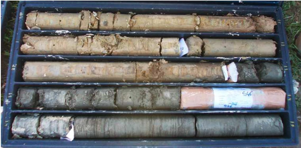
Figura 6. Marne di Gesturi, (sondaggio S46 tra 10 e 15) passaggio dalla facies alterata a quella integra.
