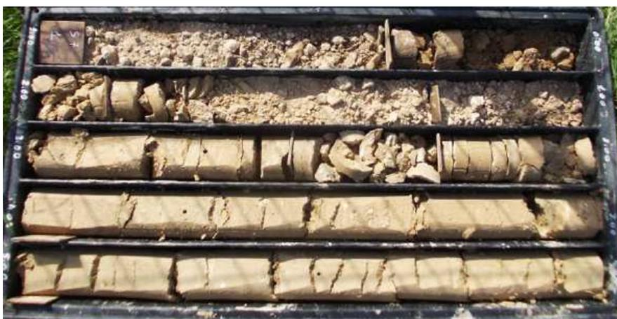
Figura 10. Litofacies  $b_{nb}$ , a prevalenza sabbiosa, carotata nel sondaggio S5 tra 0 e 5 m di profondità.
